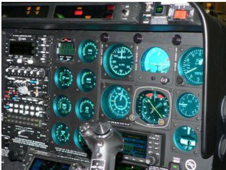
Slika 10. Kokpit zrakoplova opremljen filtrima svjetla.[13]
