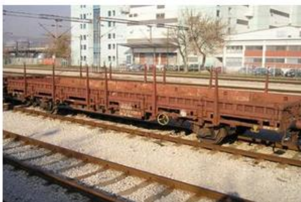
Slika 13: Vagon serije Kgs Izvor: http://www.hzcargo.hr/default.aspx?id=49
