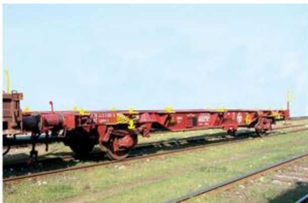
Slika 12: Vagon serije Lgnss-z Izvor: http://www.hzcargo.hr/default.aspx?id=49
