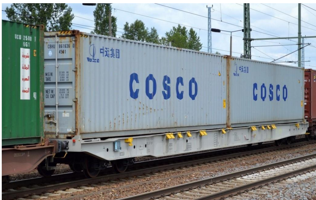
Slika 20: Vagon serije Sggnss Izvor: www.bahnbilder.de
