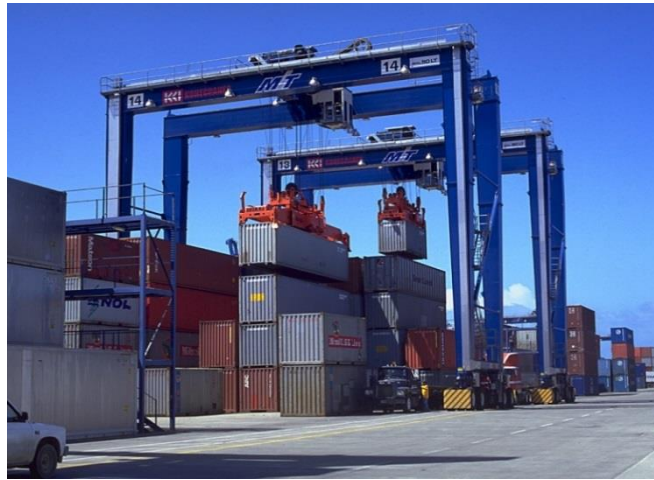
Slika 22: RTG dizalice na skladišnom prostoru Izvor: www.konecranes.com
