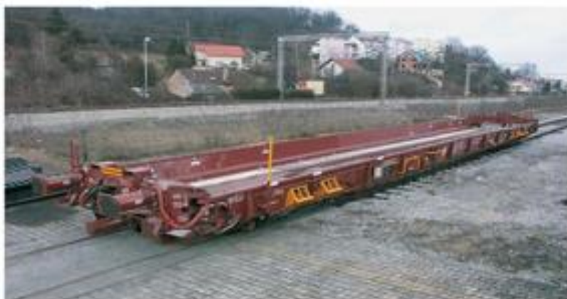
Slika 16: Vagon serije Sadkms-z Izvor: http://www.hzcargo.hr/default.aspx?id=49
