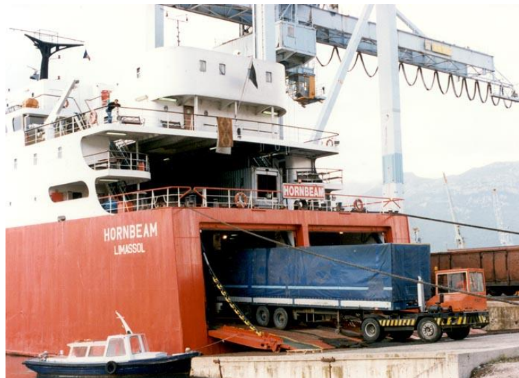
Slika 11: Prikaz iskrcaja poluprikolice RO-RO tehnologijom
