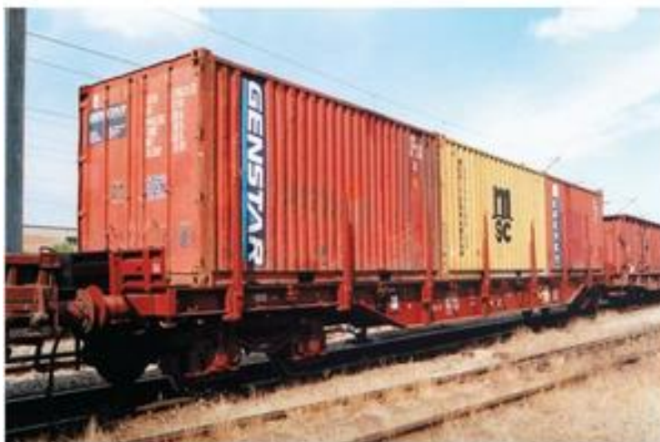
Slika 14: Vagon serije Rgs-z Izvor: http://www.hzcargo.hr/default.aspx?id=49
