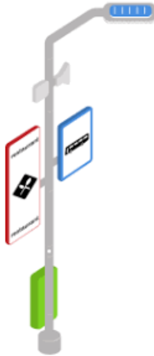
Slika 21. Višenamjenski stup javne rasvjete
