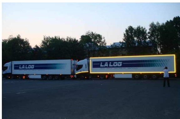
Slika 11. Primjer vidljivosti vozila označenog reflektirajućim trakama i neoznačenog u sumraku
