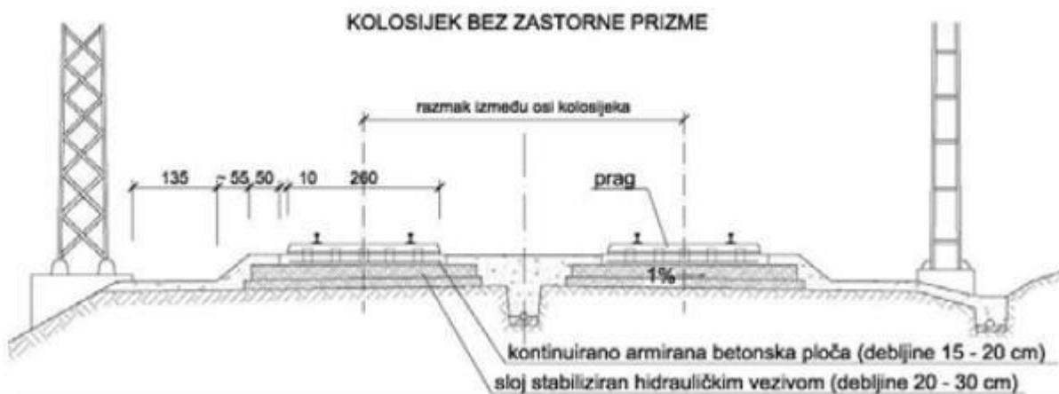
Slika 3. Poprečni presjek kolosijeka bez kolosiječnog zastora
