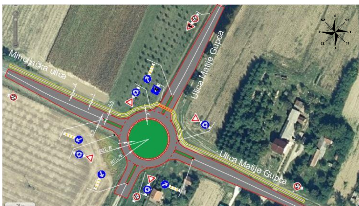
Slika 29.: Prijedlog rješenja, raskrižje s kružnim tokom prometa
