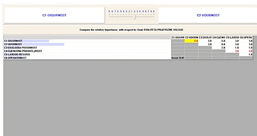
Slika 35. Postupak uspoređivanja u paru (PAIRWISE) i dodavanje težina kriterijima
