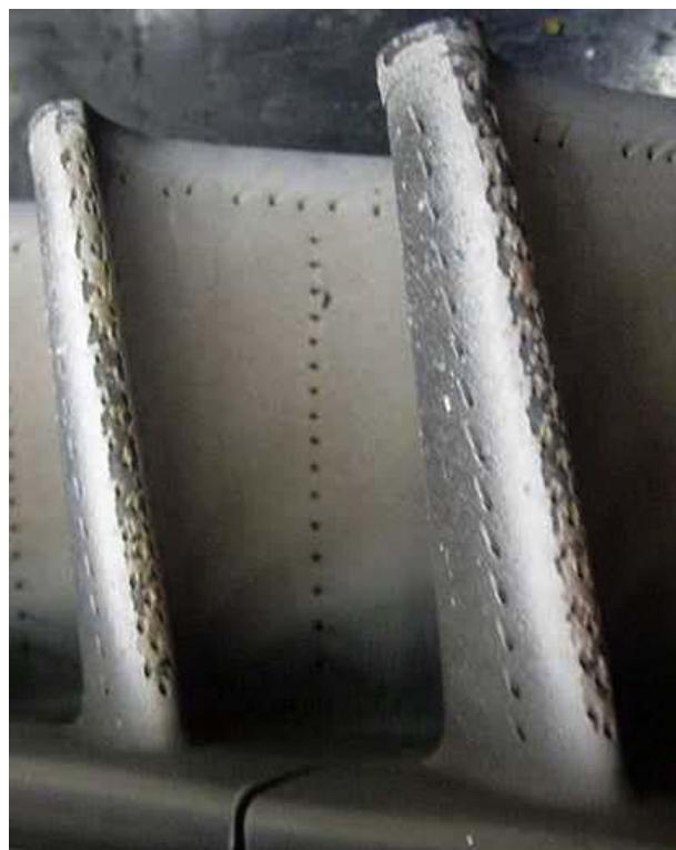
Slika 9. Oštećenje motora uzrokovano vulkanskim pepelom, [12]
