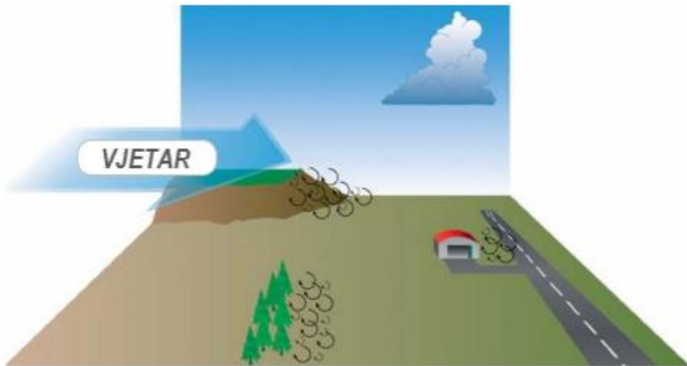
**Slika 2.** Mehanička turbulencija, [7]
