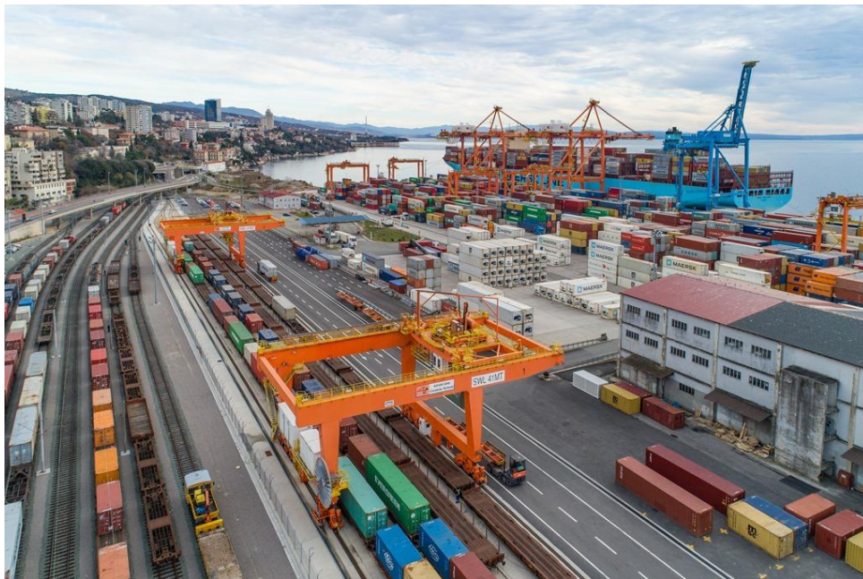
Slika 15. RMG mosna dizalica na terminalu Jadranska vrata
