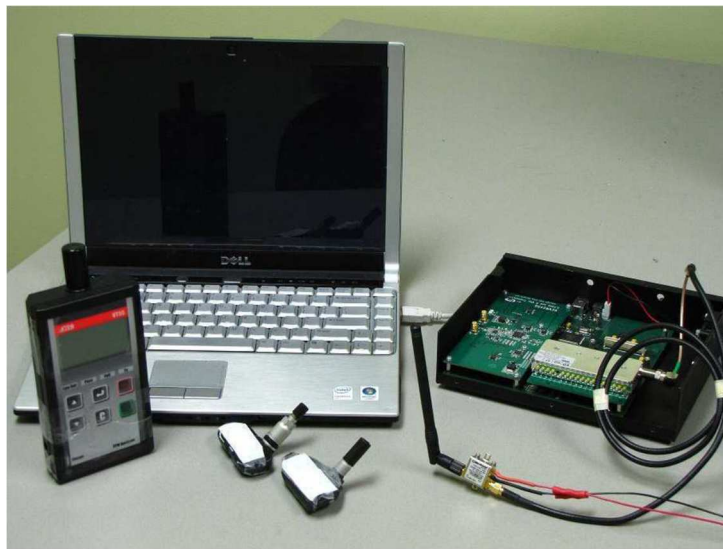
Slika 4.7. Oprema za neovlaštenu pristup povezanom vozilu kroz TPMS [28]
