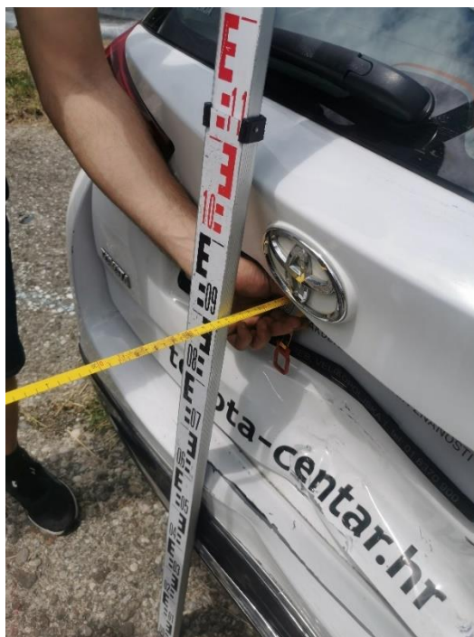
Slika 32. Mjera udubljenja stražnjeg dijela automobila
