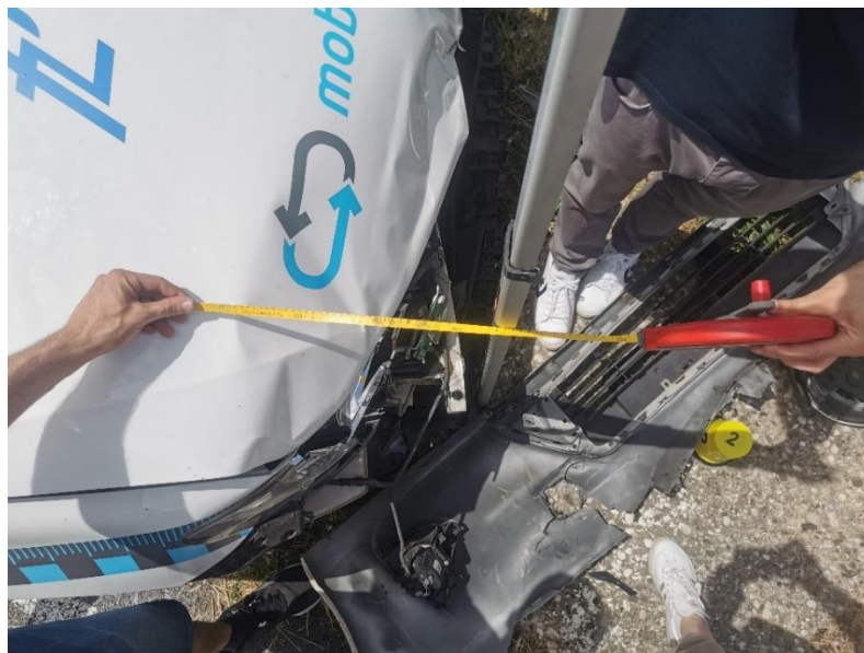
Slika 30. Mjera udubljenja pomoću mjerne letve i metra na prednjoj strani osobnog automobila
