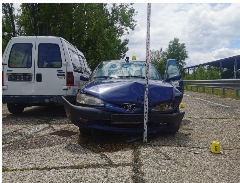
Slika 33. Mjera oštećenja prednjeg dijela automobila Peugeot
