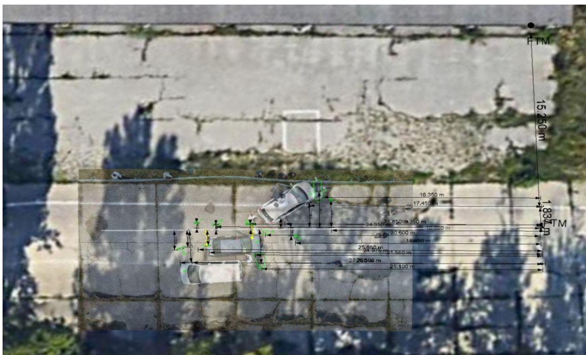
Slika 38. Prikaz mjera tragova pomoću simulacijskog alata PC Crash
