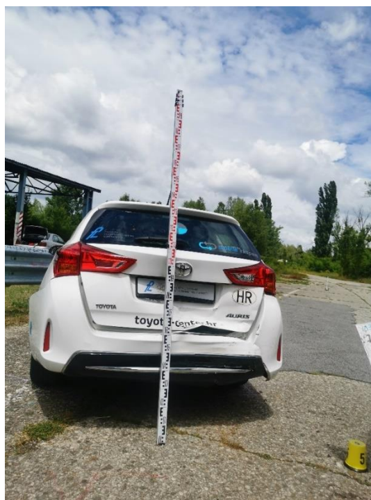
Slika 31. Mjera oštećenja na stražnjoj strani osobnog automobila
