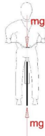
Slika 31. Uvjet ravnoteže sustava u stacionarnom položaju - stražnji pogled Izvor: [6]
