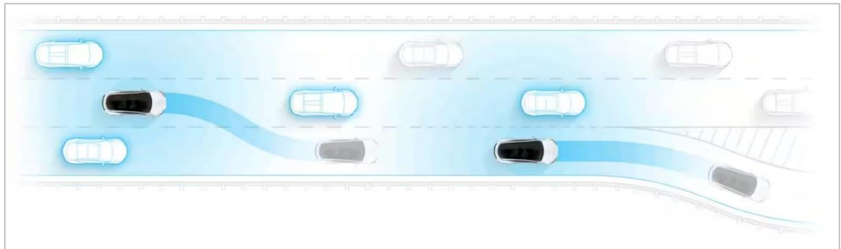
Slika 24. Izlazak s autoceste pomoću autopilota, [31]
