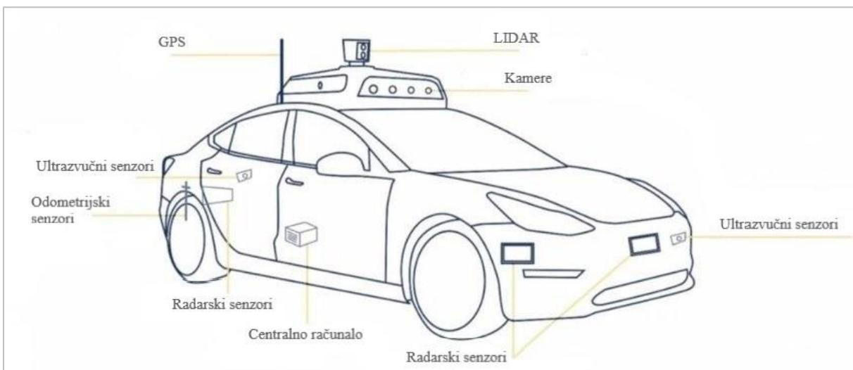
Slika 1. Senzorski sustavi na potpuno automatiziranom automobilu
