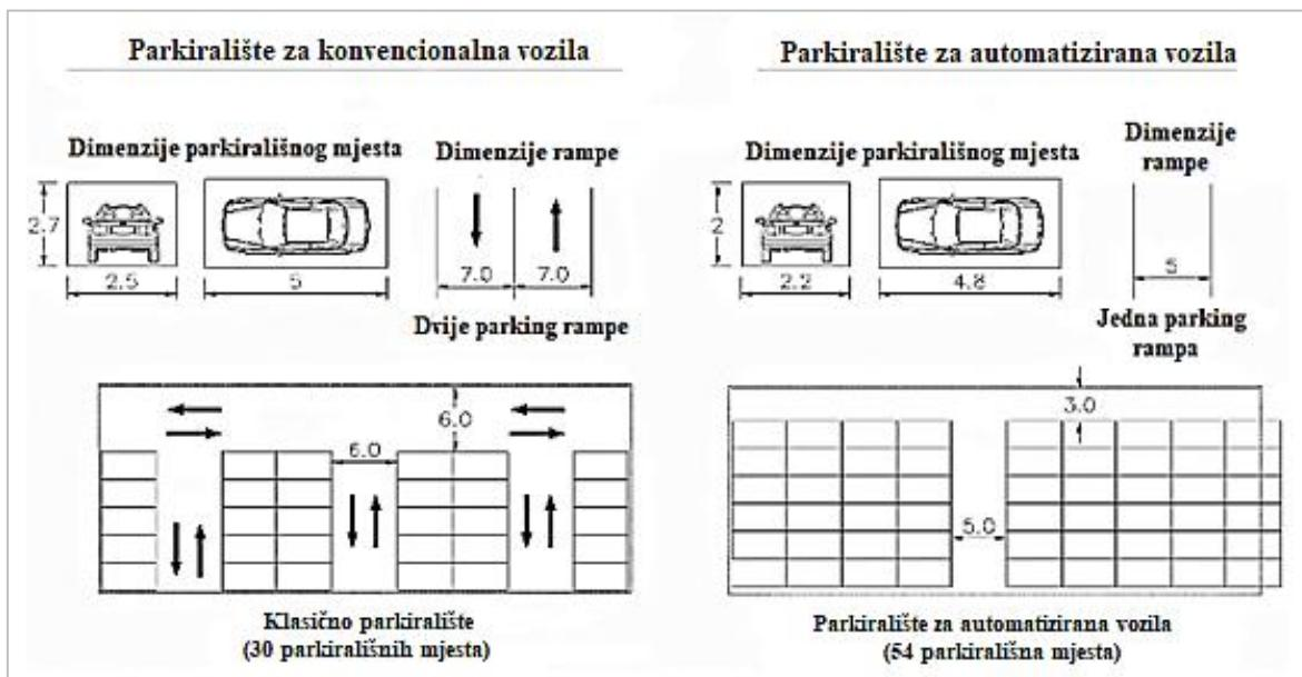
Slika 35. Izgled parkirališnih mesta za konvencionalna vozila i za autonomna vozila s predloženom tehnikom blokiranja
