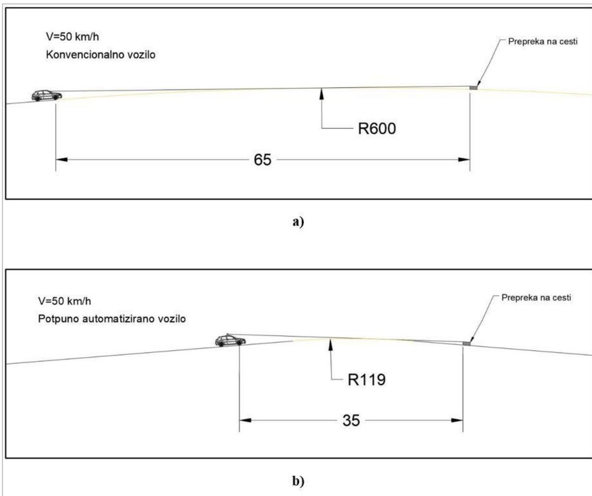
Slika 30. Minimalni polumjer konveksnog vertikalnog zaobljenja nivelete za konvencionalna vozila (a) i za AV-ove (b) – konceptualni prikaz
