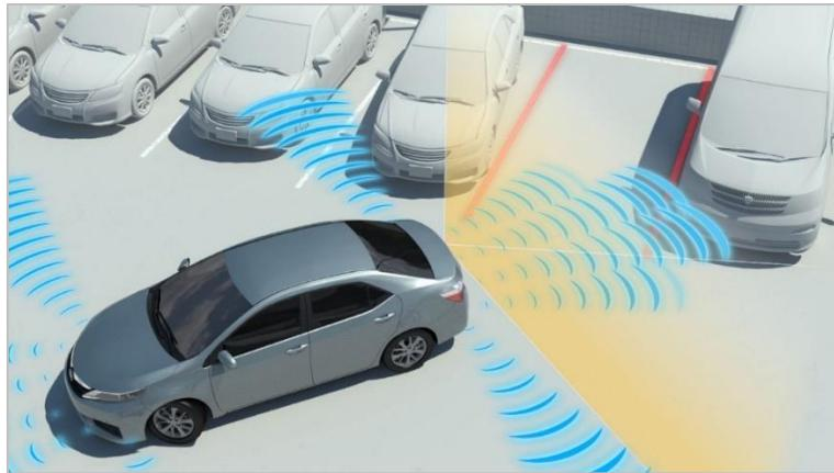
Slika 6. Odašiljanje akustičnih valova pomoću ultrazvučnih senzora, [11]
