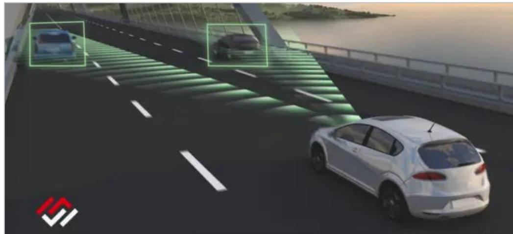
Slika 14. Detekcija objekata pomoću radara, [24]
