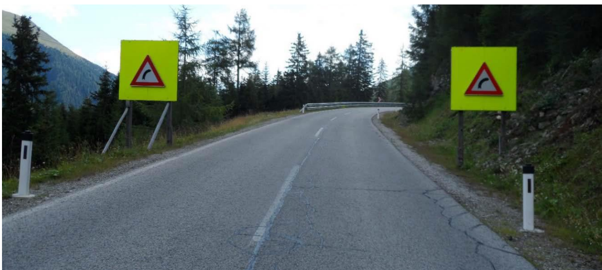
Slika 21. Prometni znak najave zavoja dodatno naglašen žuto-zelenom fluorescentnom podlogom Izvor: [58]
