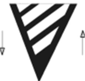
*Slika 12. Polja za usmjerivanje prometa između dva traka sa suprotnim smjerovima (H27)*
