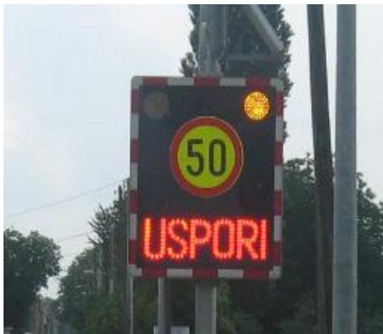
*Slika 56. Ograničenje brzine s porukom „USPORI“*
