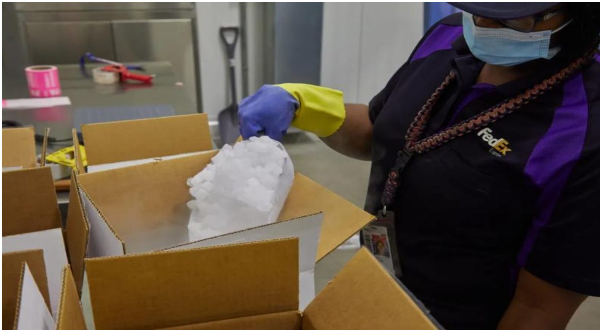
Slika 7. Priprema suhog leda za prijevoz, [21]
