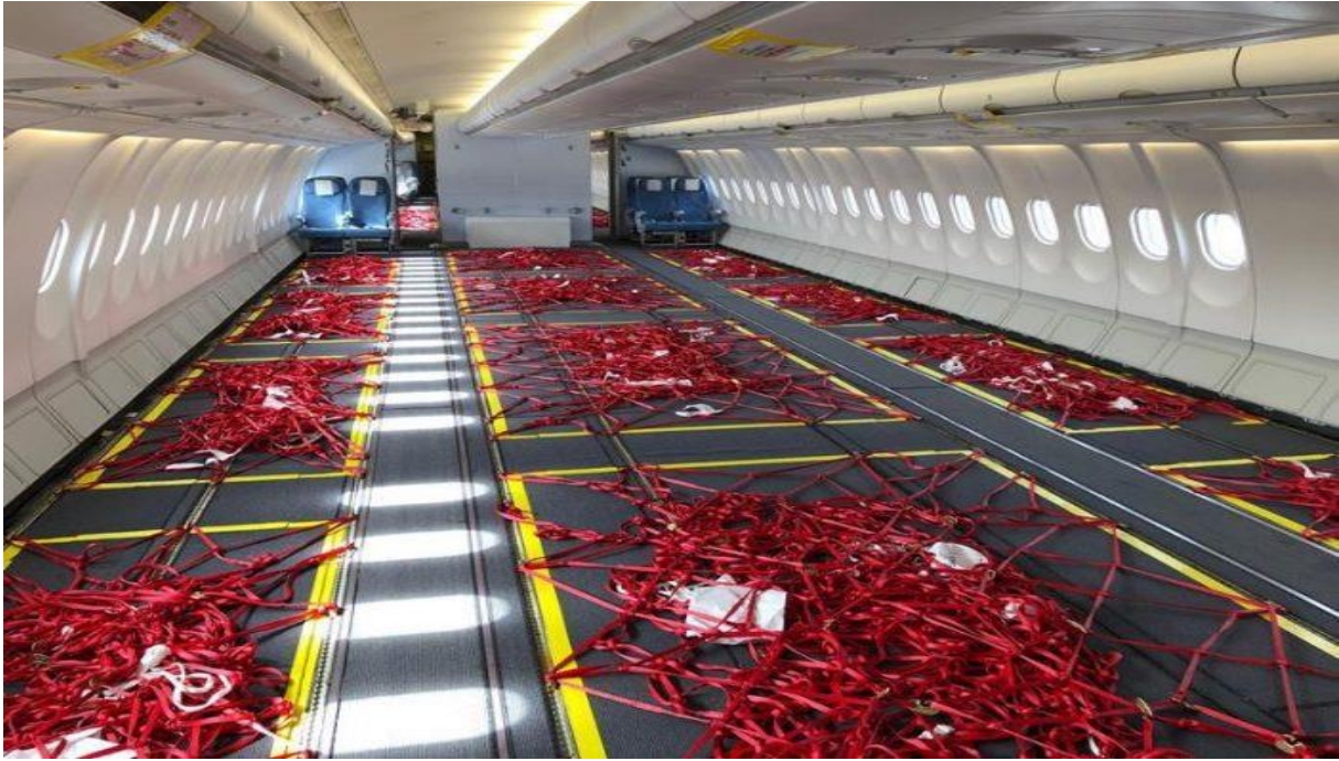
Slika 4. Putnička kabina A330 nakon uklanjanja sjedala, [16]
