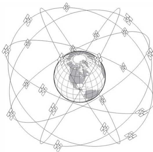
Slika 2. Položaj orbita GPS satelita
