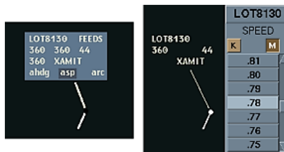
Slika 17. Odabir brzine u Machovom broju iz padajućeg izbornika [4]
