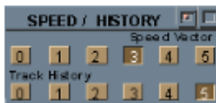
Slika 7. Izbornik vektora brzine i prijedene putanje [4]
