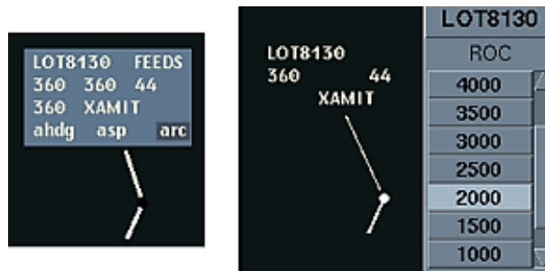
Slika 15. Odabir brzine uzdizanja iz padajućeg izbornika [4]
