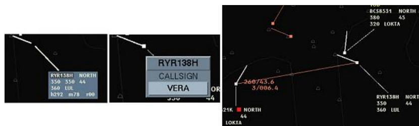
Slika 20. Mjerenje minimalne udaljenosti alatom VERA [4]
