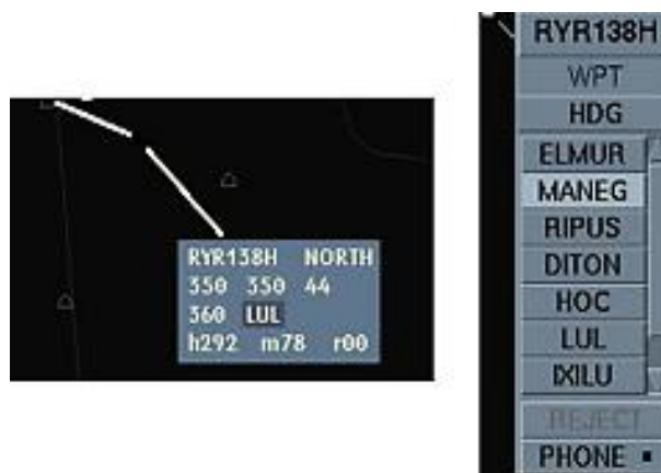
Slika 16. Odabir točke iz padajućeg izbornika [4]
