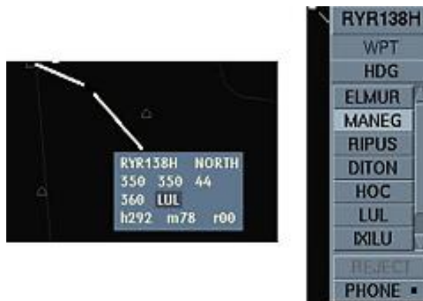
Slika 16. Odabir točke iz padajućeg izbornika [4]
