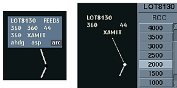
Slika 15. Odabir brzine uzdizanja iz padajućeg izbornika [4]
