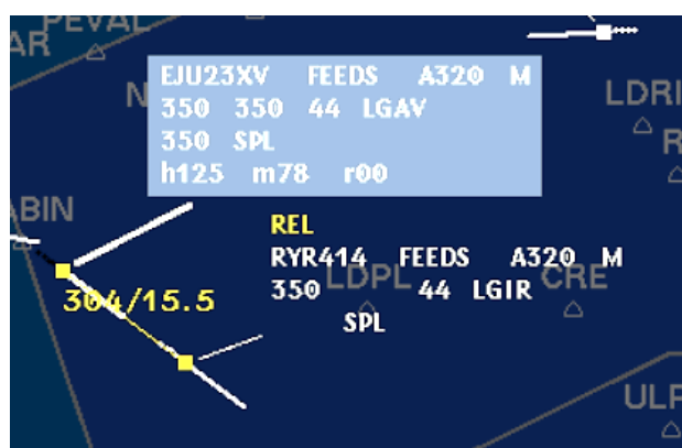
Slika 47. Vježba C, Prometna situacija 2, Spajanje zrakoplova alatom za mjerenje
