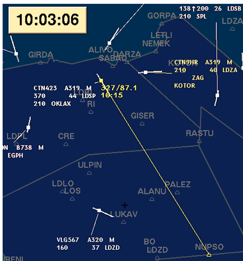
Slika 42. Vježba B, Mjerenje udaljenosti između zrakoplova i točke NUPSO
