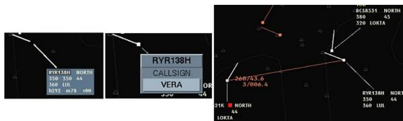
Slika 20. Mjerenje minimalne udaljenosti alatom VERA [4]
