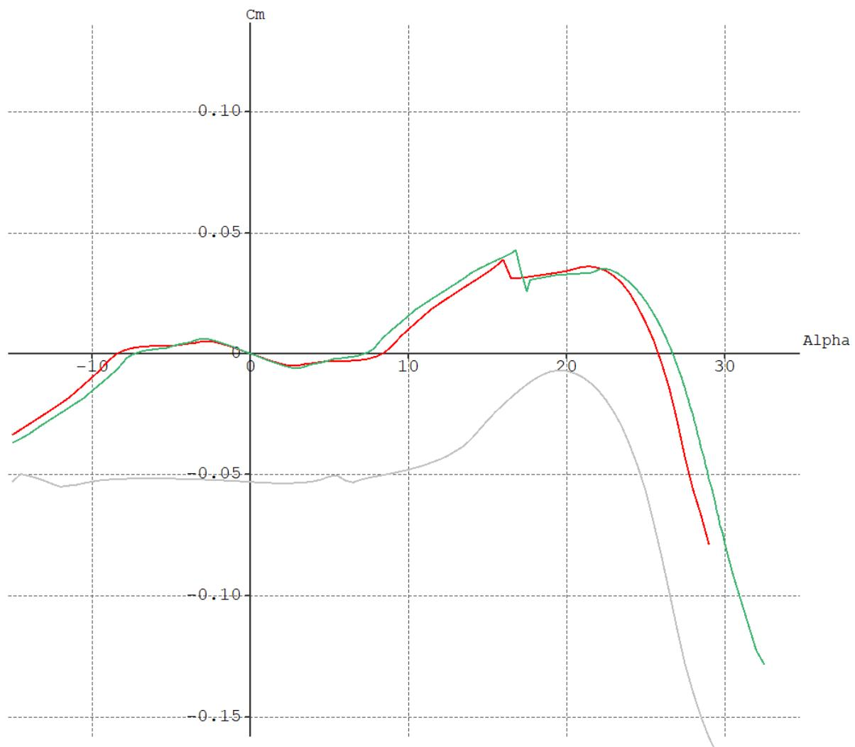
Slika 17 Ovisnost koeficijenta momenta o napadnom kutu za aeroprofile NACA 65<sub>3</sub>-018, 65<sub>3</sub>-019 i NACA 2412 (označen sivo).
