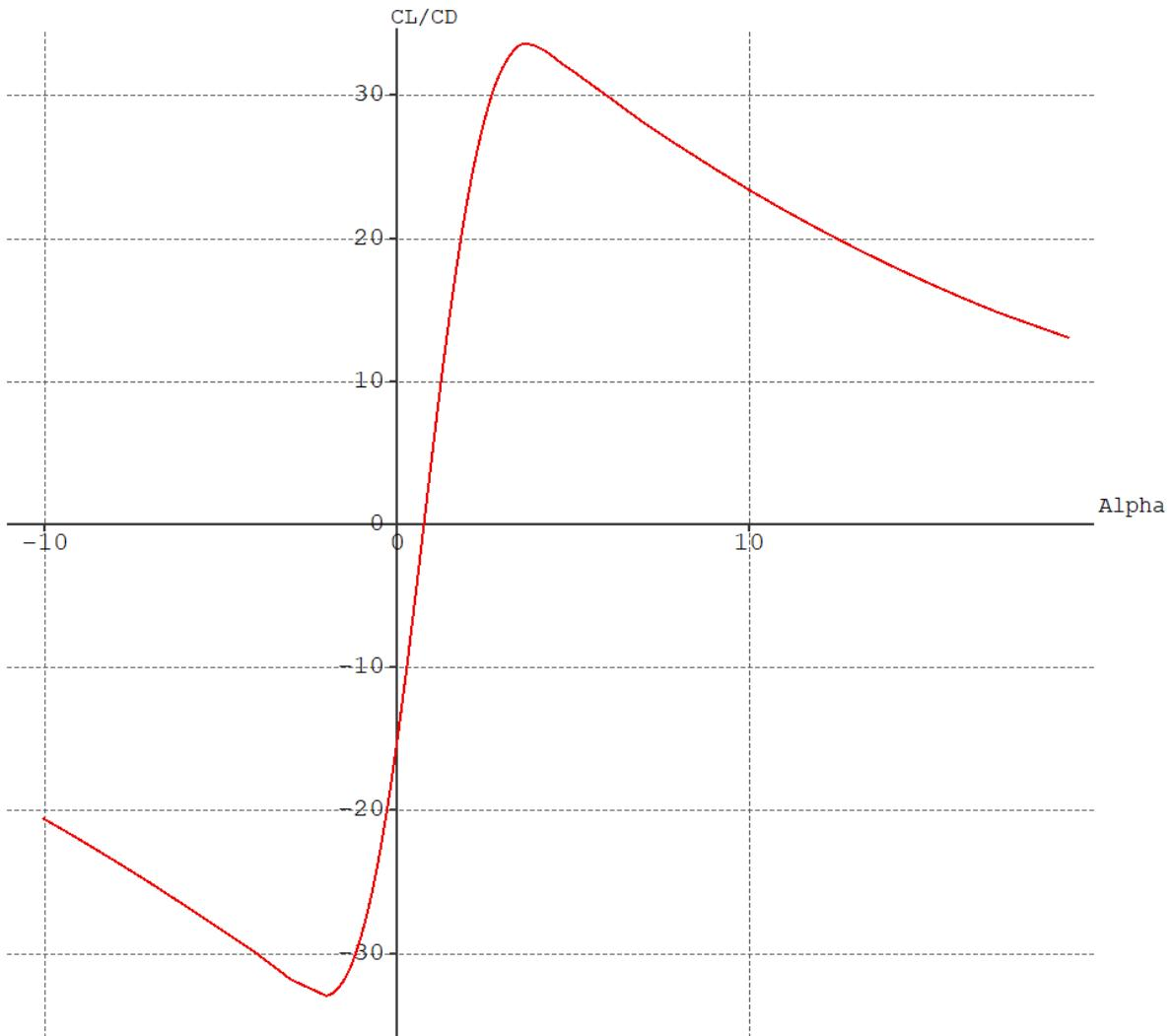
Slika 30 Ovisnost omjera  $C_L/C_D$  i napadnog kuta.
