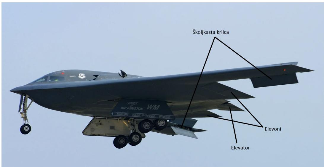
Slika 36 Northrop Grumman B-2 Spirit prije slijetanja.
