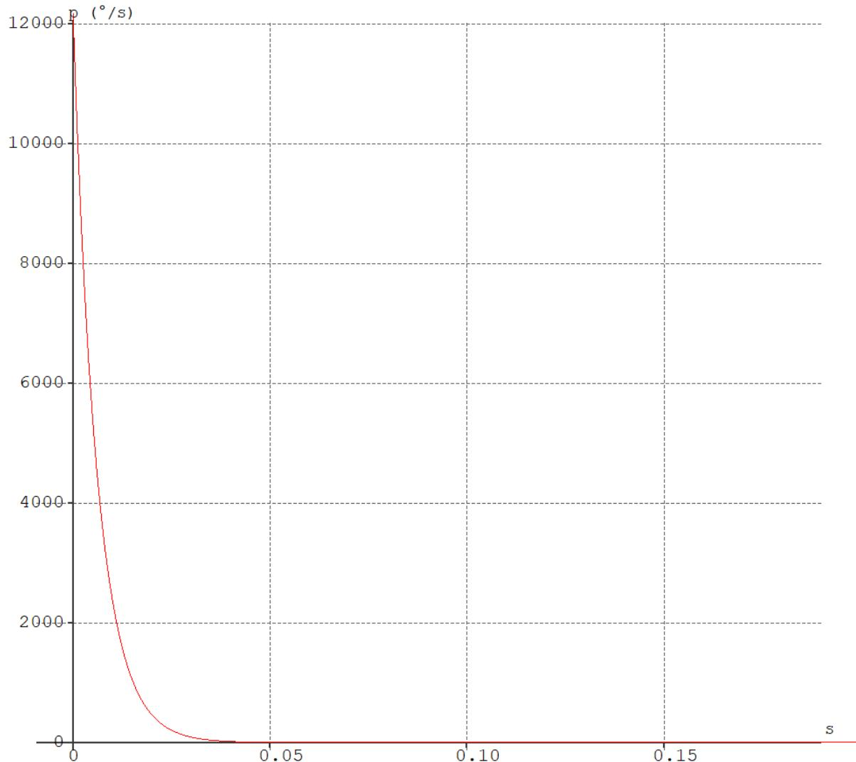
Slika 42 Promjena kutne brzine valjanja s vremenom.
