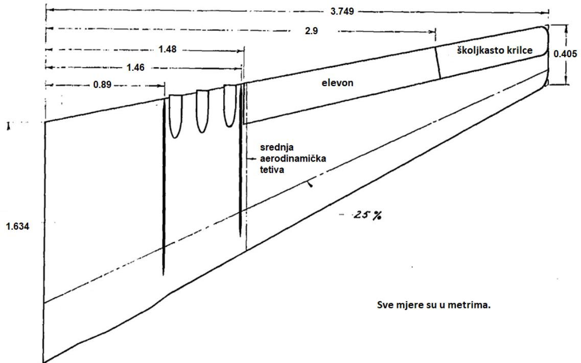
Slika 9 Nacrt modela polovičnog raspona YB-49 u mjerilu 1/7.
