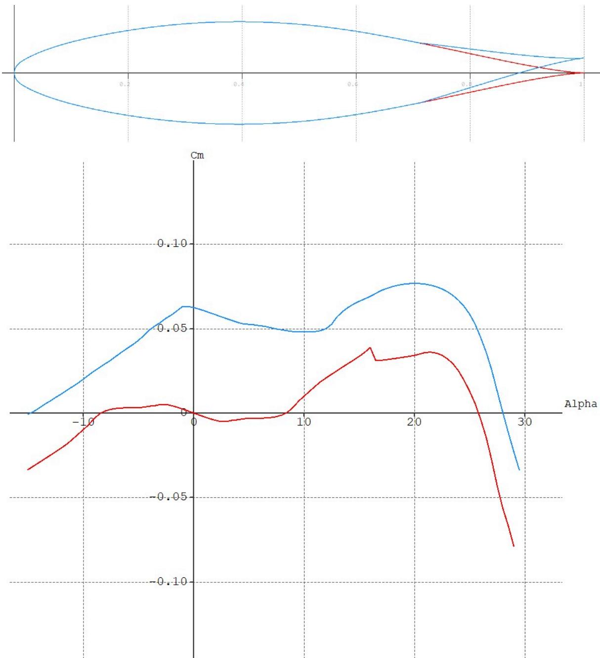
Slika 18 Usporedba aeroprofila NACA 65<sub>3</sub>-018 i modificiranog 65<sub>3</sub>-018 sa relex-om.
