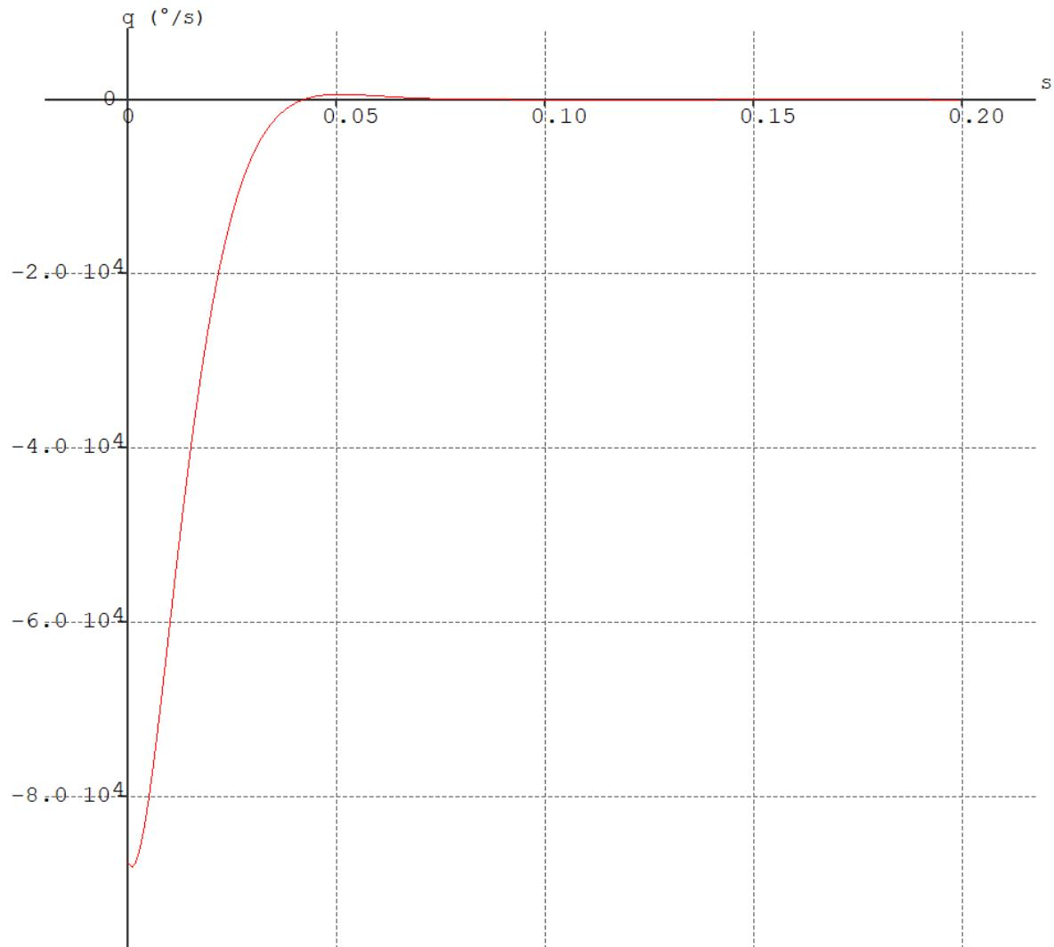
Slika 38 Ovisnost promjene kutne brzine propinjanja o vremenu.
