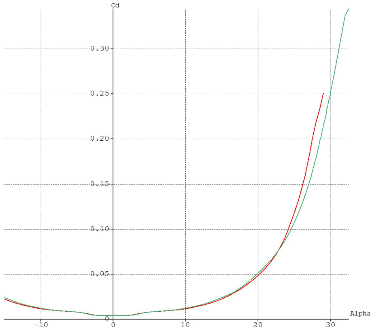
Slika 15 Ovisnost koeficijenta otpora o napadnom kutu za aeroprofile NACA 65<sub>3</sub>-018 i 65<sub>3</sub>-019.
