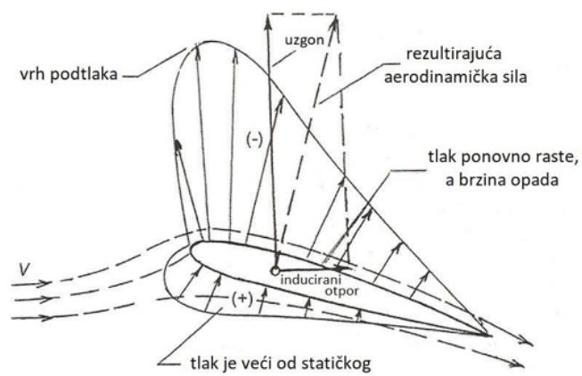
Slika 24 Shema induciranoj otpore krila.
