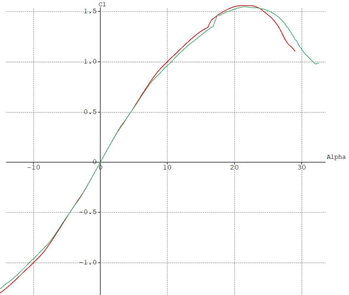
Slika 14 Ovisnost koeficijenta uzgona o napadnom kutu za aeroprofile NACA 65<sub>3</sub>-018 i 65<sub>3</sub>-019.
