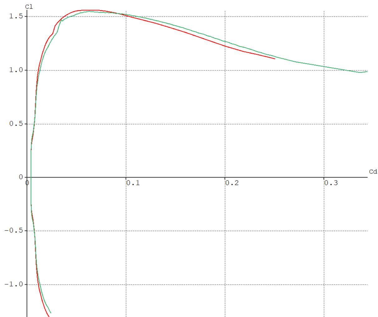
Slika 16 Ovisnost koeficijenta uzgona o koeficijentu otpora za aeroprofile aeroprofile NACA 65<sub>3</sub>-018 i 65<sub>3</sub>-019.
