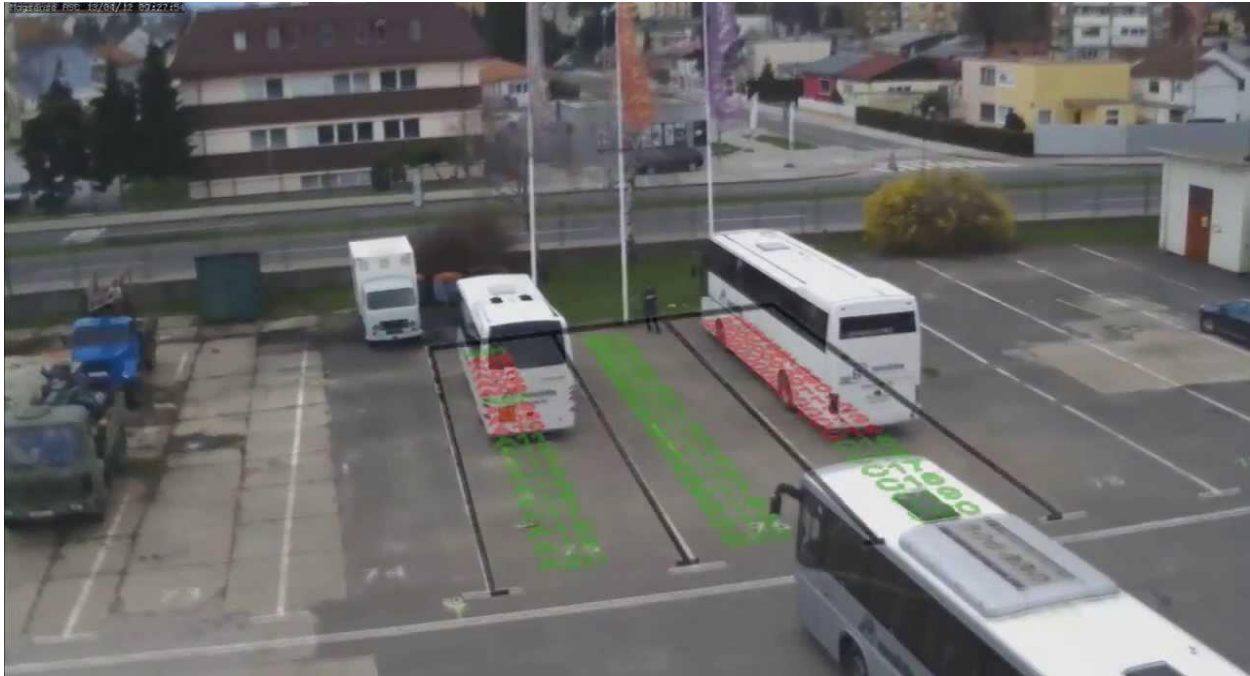
Slika 7: Magsense detektor u funkciji pomoći pri parkiranju
