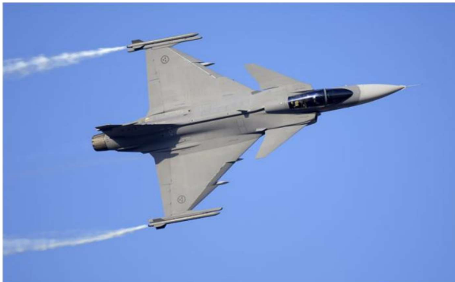
Slika 24. Borbeni zrakoplov u canard izvedbi [12]
