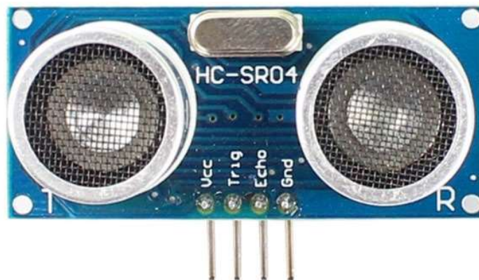
Slika 13 HC-SR04 ultrazvučni senzor [7]
