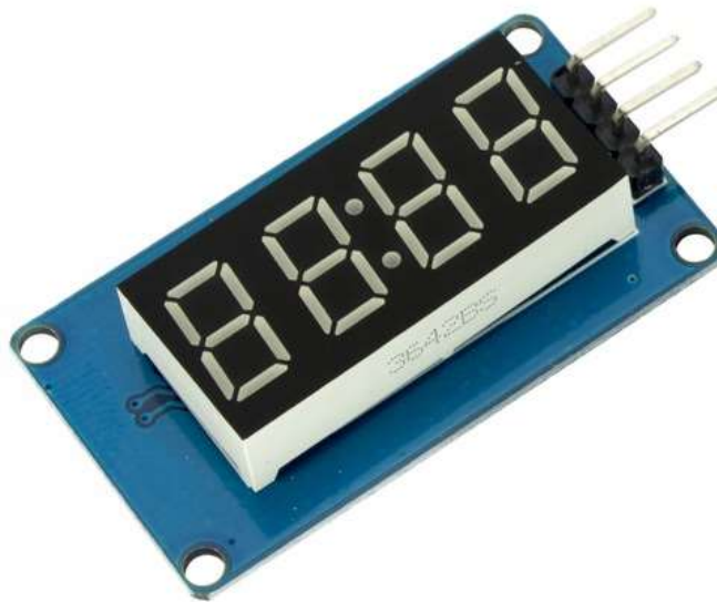
Slika 14 TM1637 7-segmentni LED brojčani prikaznik [7]
