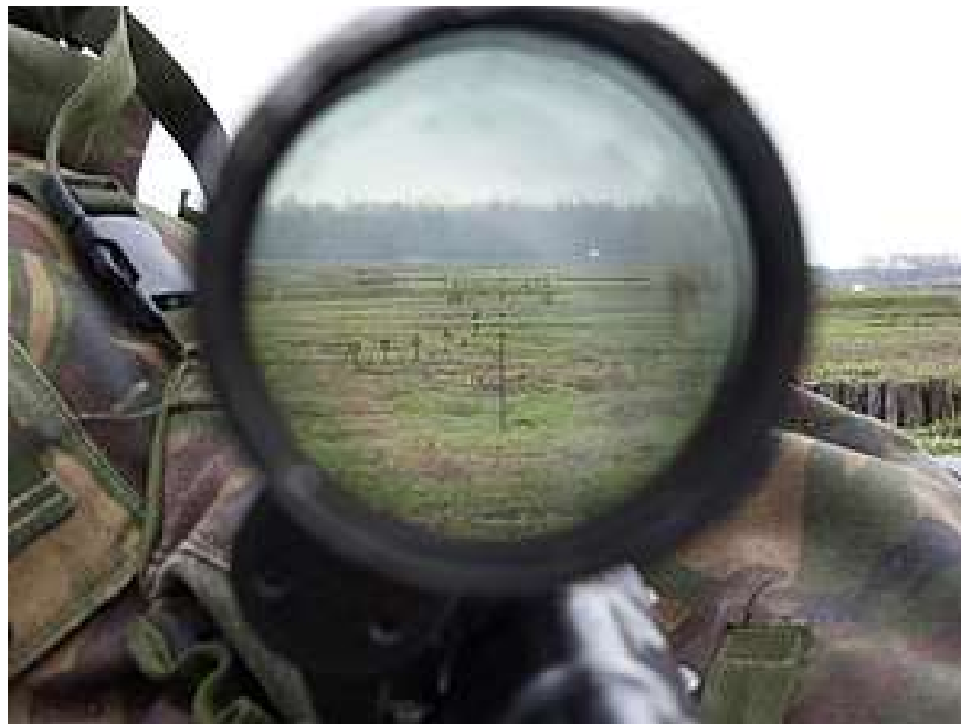
Slika 2 Optika sa stadiometrijskim daljinomjerom [2]
