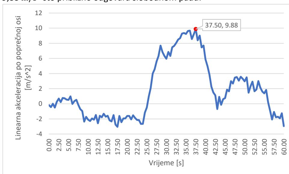
Graf 32. Linearna akceleracija po poprečnoj osi zrakoplova
