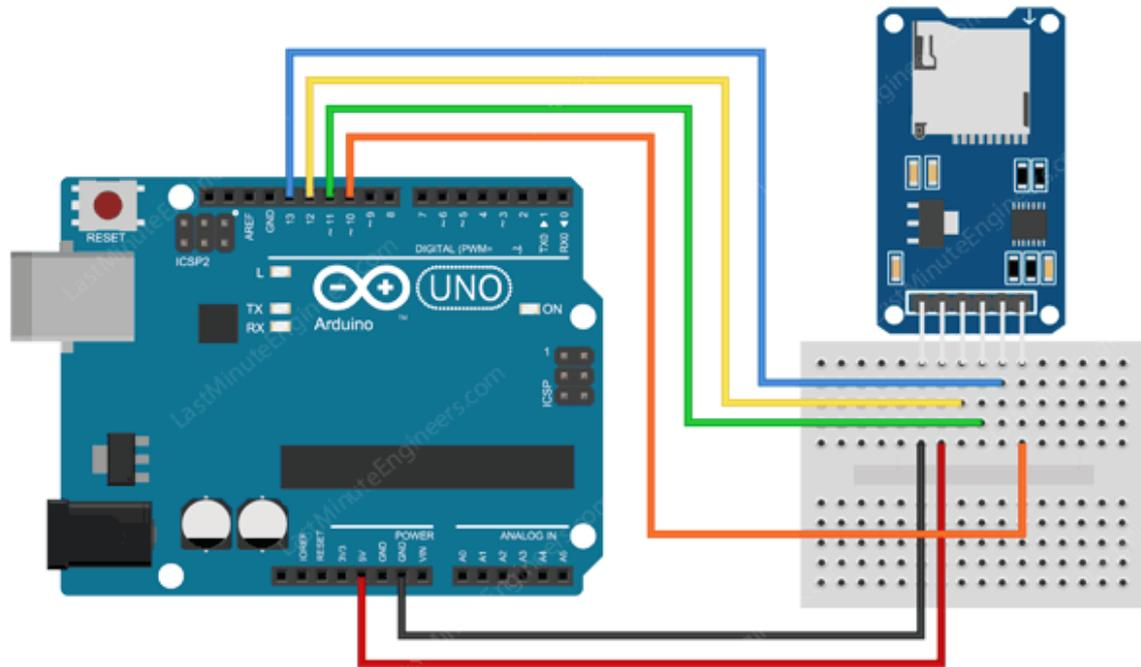
Slika 4. Shema spajanja modula za MicroSD karticu sa uređajem *Arduino Uno*.
