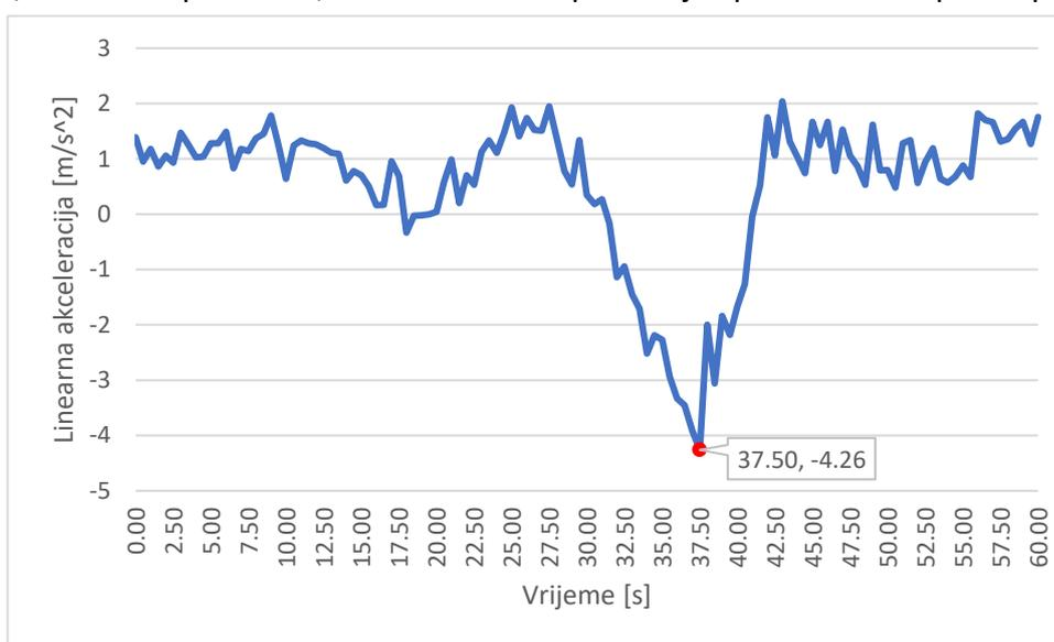
Graf 35. Linearna akceleracija po uzdužnoj osi zrakoplova
