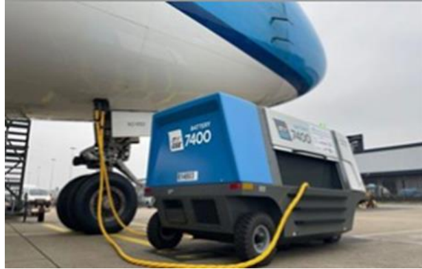
Slika 22. 7400 e-GPU u Zračnoj luci Schiphol Amsterdam Izvor: [32]
