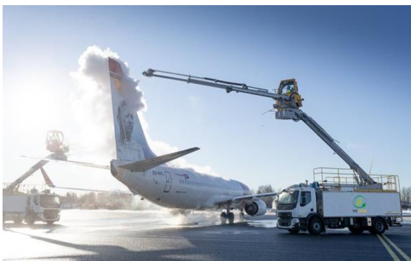
Slika 20. Električni odleđivač Elephant e-BETA u zračnoj luci Helsinkij Izvor: [30]
