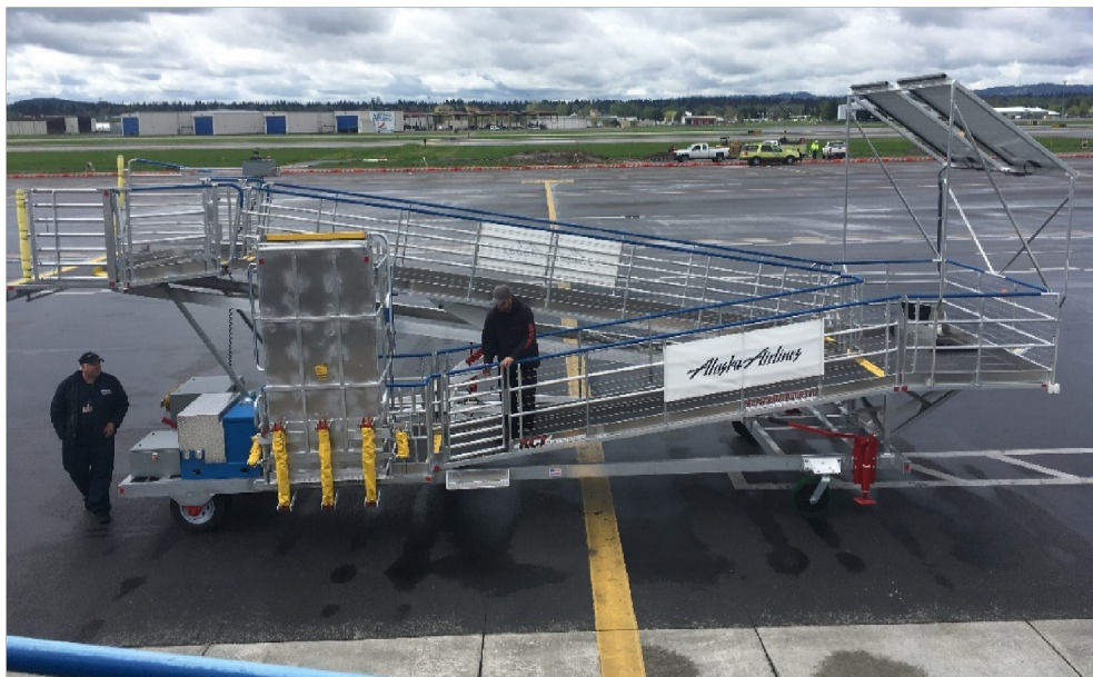
Slika 30. Električno - hidraulična platforma
