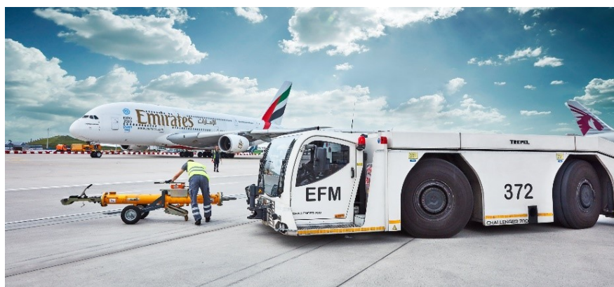
Slika 16. Traktor za izguravanje zrakoplova s pozicije
