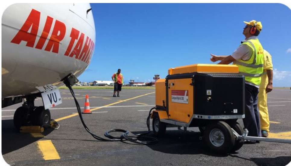
Slika 5. Zemaljski izvor električne energije
