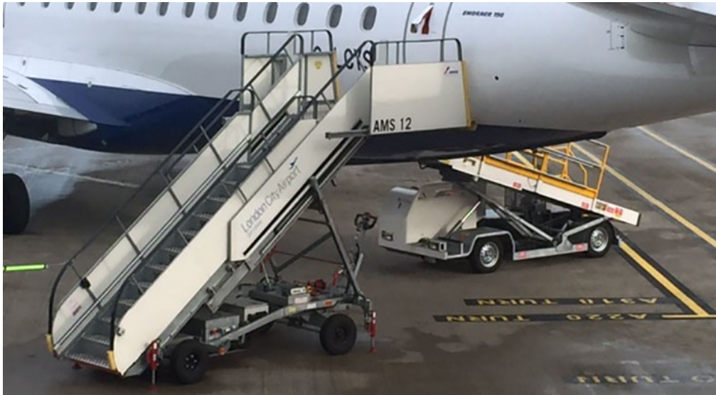
Slika 28. Prikaz električnih stepenica
