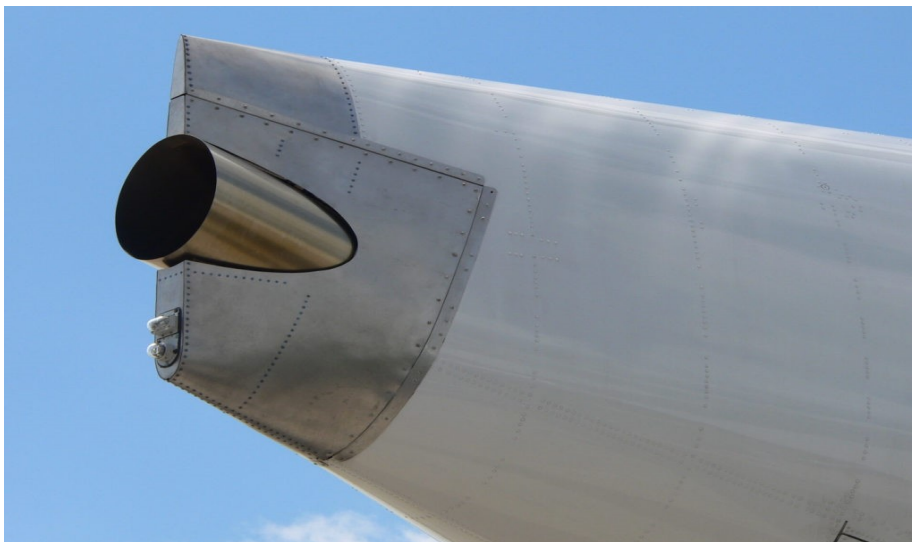
Slika 14. Današnji izgled pomoćne pogonske jedinice
