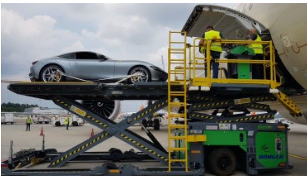
Slika 25. Prikaz Ranger 15E električnog utovarivača tereta
