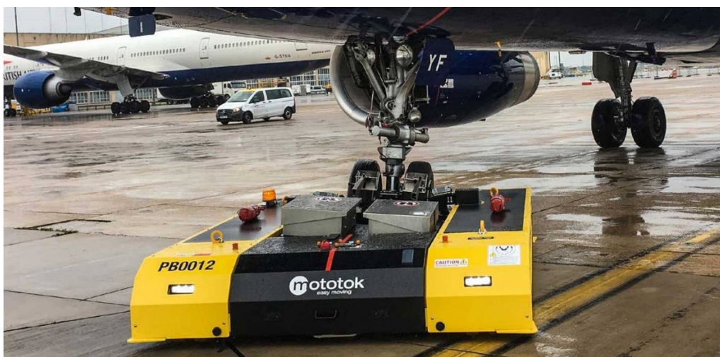
Slika 22. Prikaz Mototok vučnog tegljača
