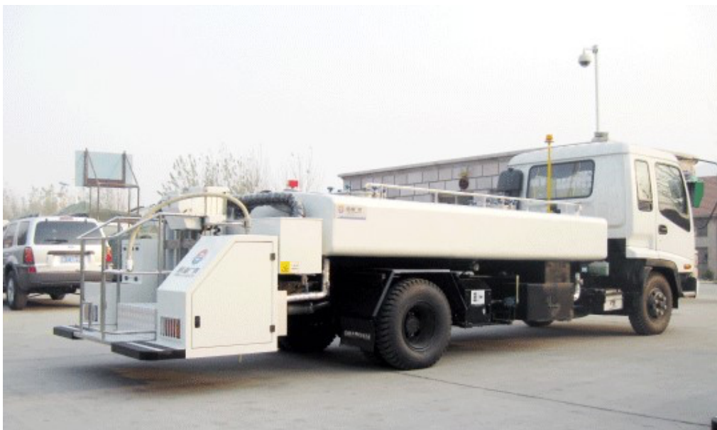
Slika 33. Vozilo za opskrbu zrakoplova pitkom vodom
