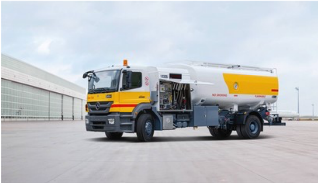
Slika 32. Cisterna za opskrbu zrakoplova gorivom tvrtke Esterer
