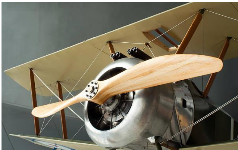
Slika 11. Prikaz drvene elise zrakoplova
