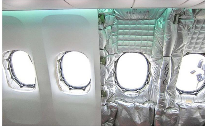
Slika 15. Prikaz izolacije zidova zrakoplova stiroporom
