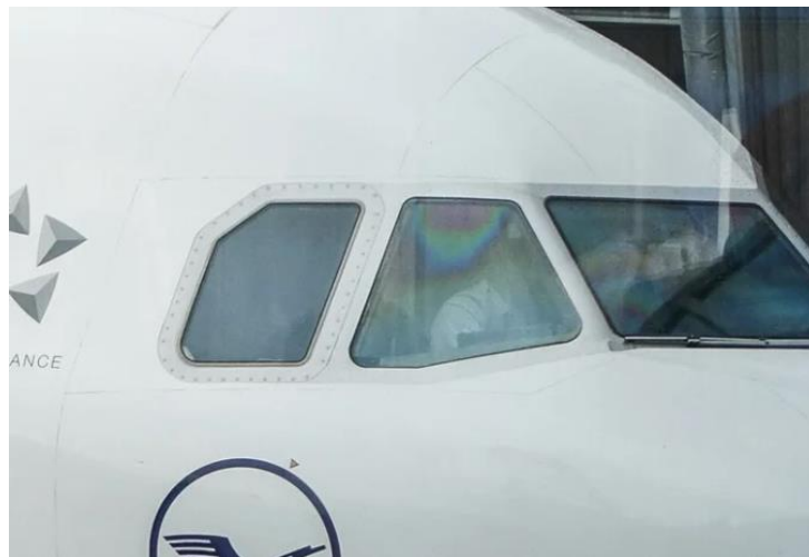
Slika 13. Prozori na zrakoplovu izrađeni od pleksi stakla
