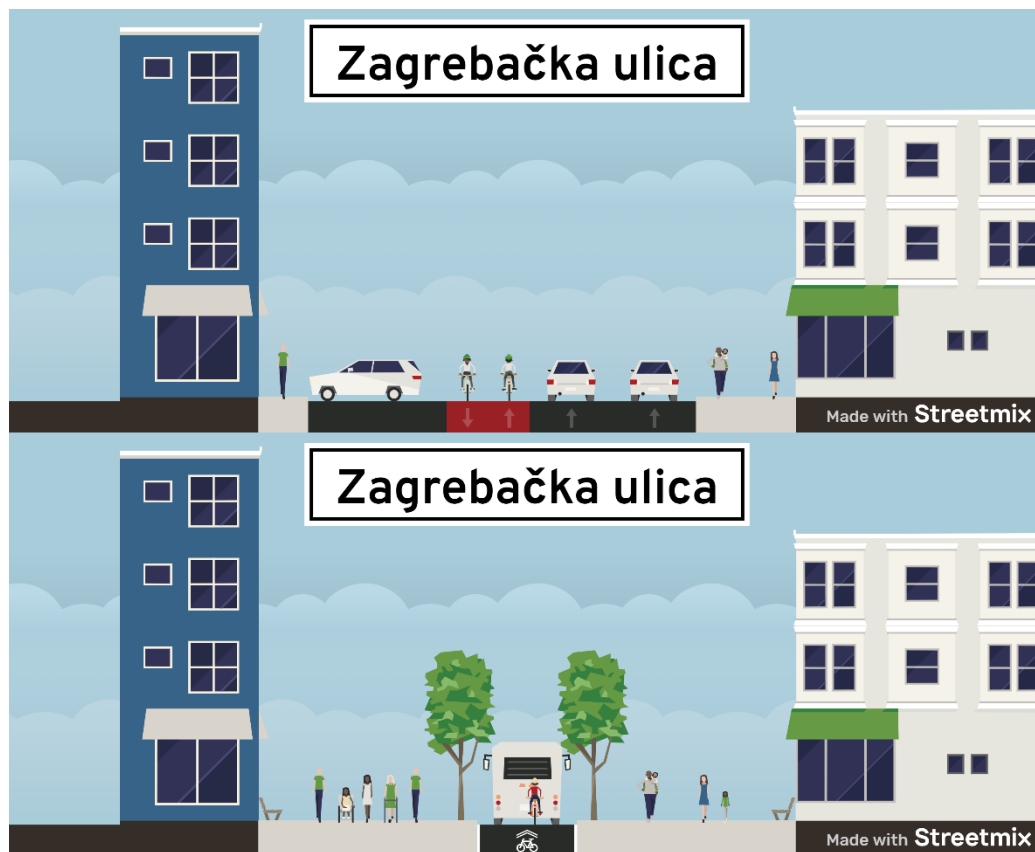
Slika 21. Promjena poprečnog profila dijela Zagrebačke ulice prilikom prenamjene u pješačku ulicu Izvor: [73] – Obrada autora
