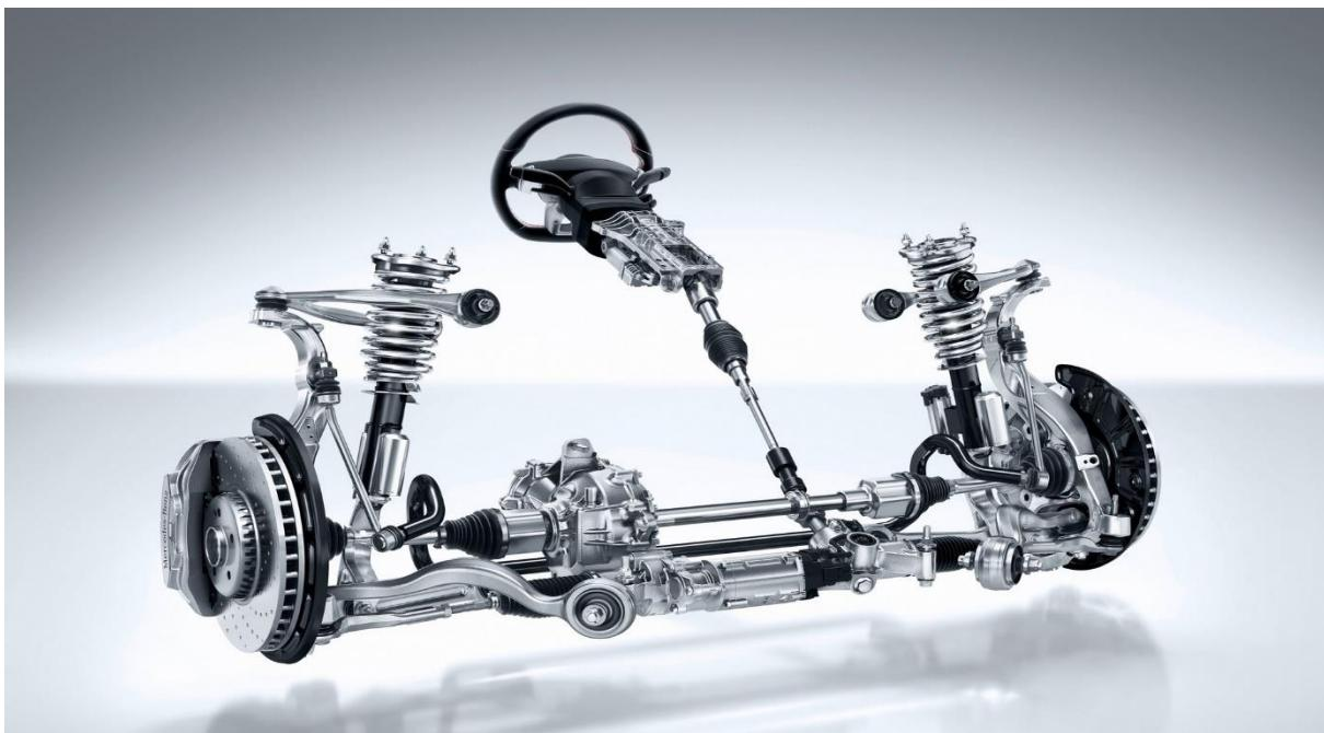
*Slika 8. Konstrukcija EPS-a [16]*
