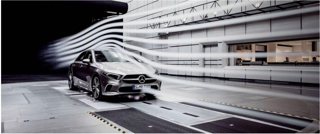
Slika 17. Ispitivanje aerodinamike vozila u zračnom tunelu [25]
