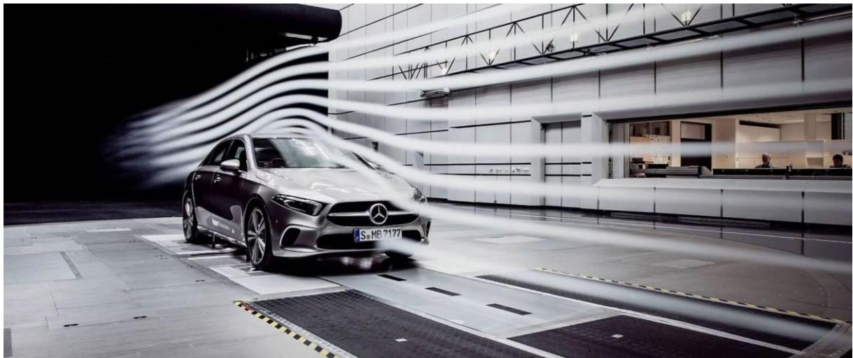
*Slika 17. Ispitivanje aerodinamike vozila u zračnom tunelu [25]*
