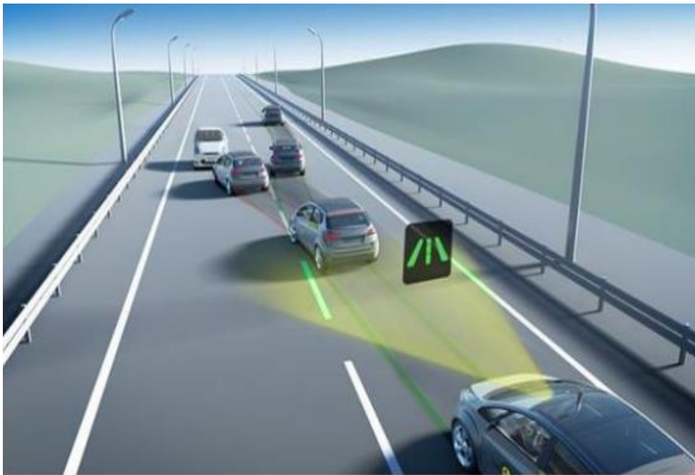
Slika 18. Prikaz aktiviranja LKA sustava
