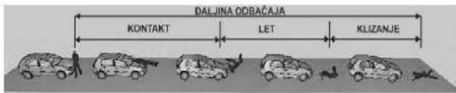
Slika 4. Faze potpunog frontalnog naleta
