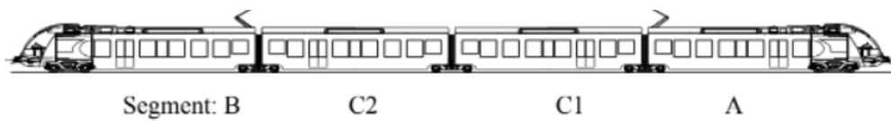
Slika 5. Konfiguracija elektromotornog vlaka 6112
