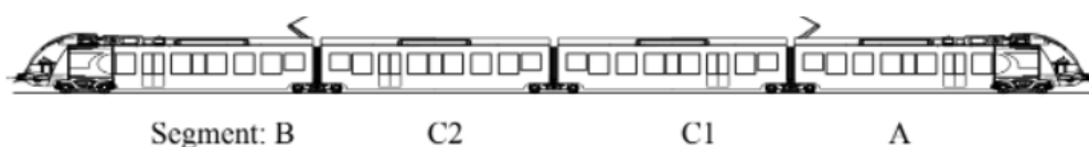
Slika 5. Konfiguracija elektromotornog vlaka 6112
