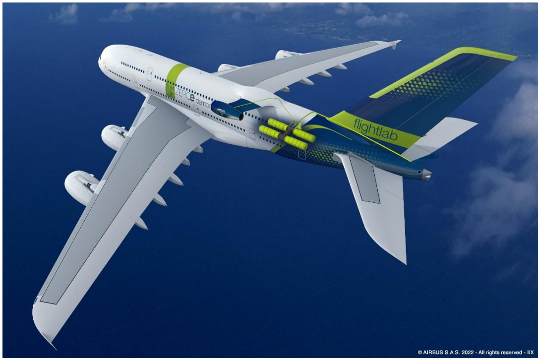
Slika 6. Položaj spremnika tekućeg vodika u zrakoplovu, (36)
