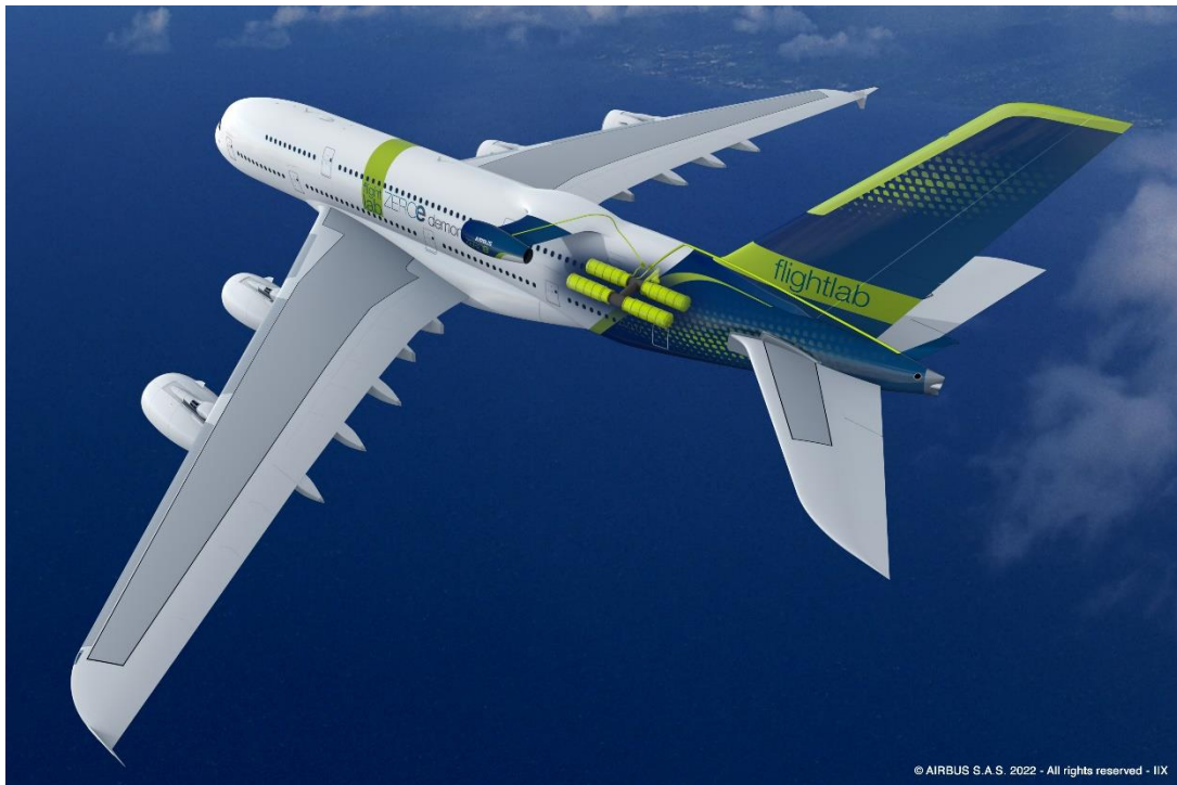
Slika 6. Položaj spremnika tekućeg vodika u zrakoplovu, (36)
