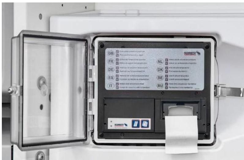
Slika 8. Prikaz termografa sa S.KO COOL poluprikolice [15]
