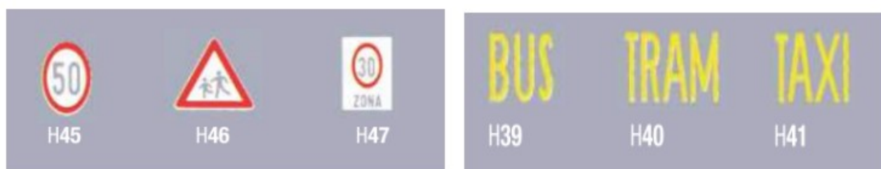
Slika 12. Natpisi i simboli izvedeni kao oznake na kolniku
