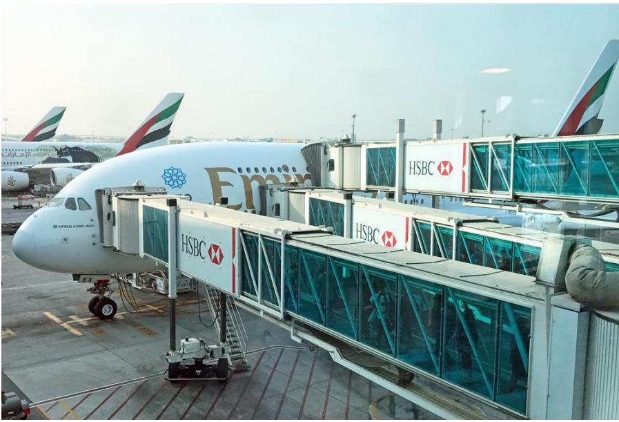
**Slika 22.** Tri aviomosta spojena na zrakoplov Airbus A380
