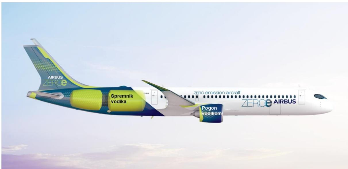
**Slika 27.** Konceptni zrakoplov Airbus ZEROe
