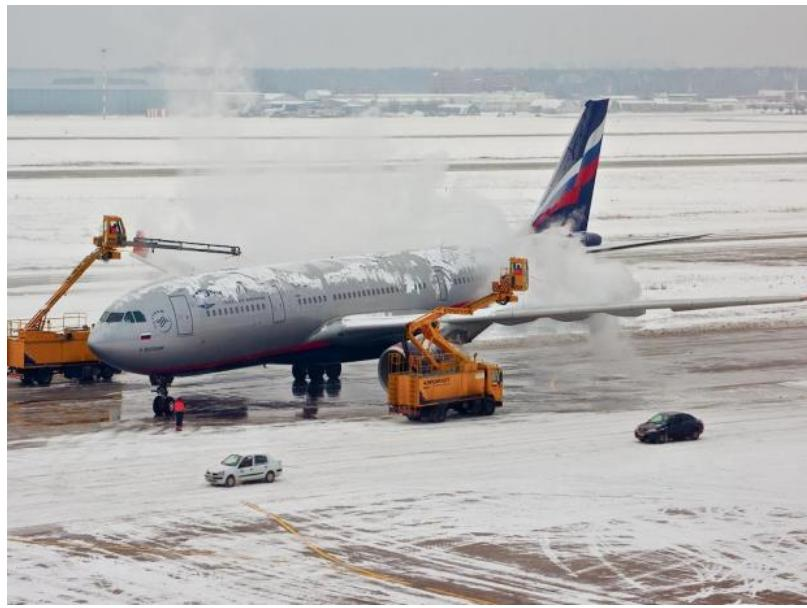
**Slika 12.** Stajanka za odleđivanje i zaštitu zrakoplova protiv zaleđivanja
