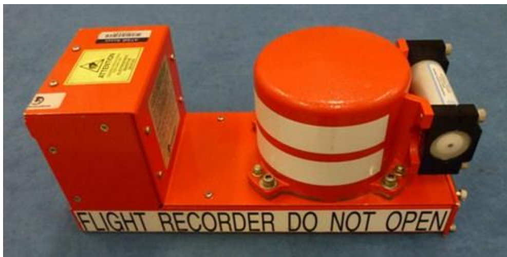
Slika 3. Uređaj za snimanje zvuka u kokpitu
