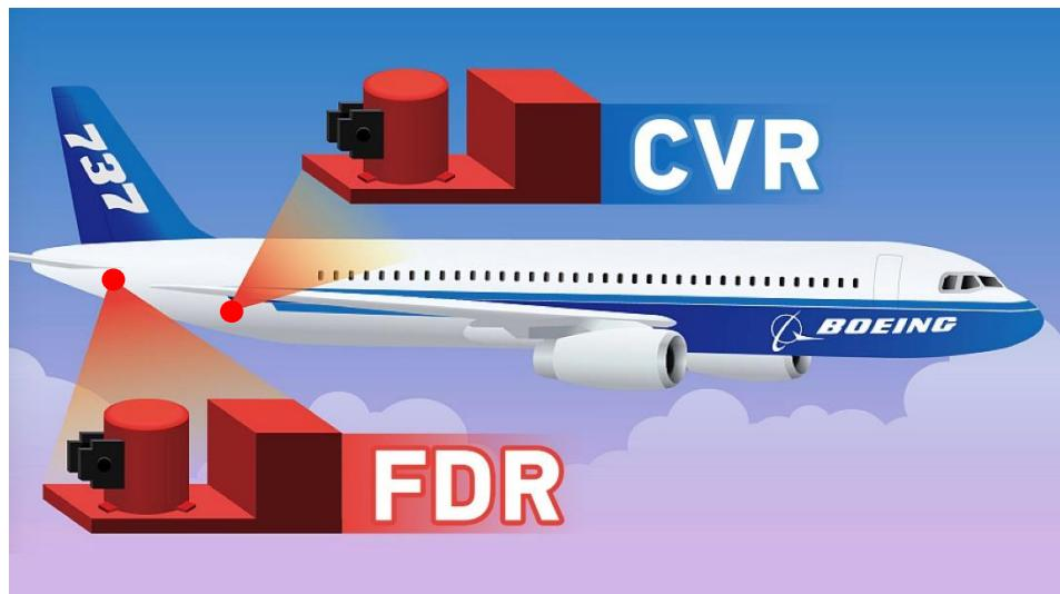
**Slika 4.** Lokacija FDR i CVR uređaja u zrakoplovu
