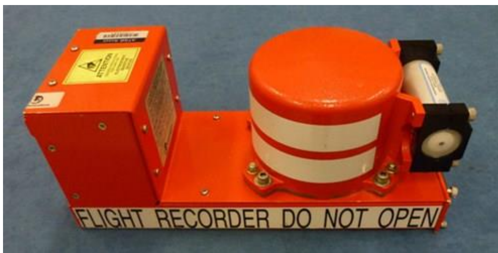
Slika 3. Uređaj za snimanje zvuka u kokpitu
