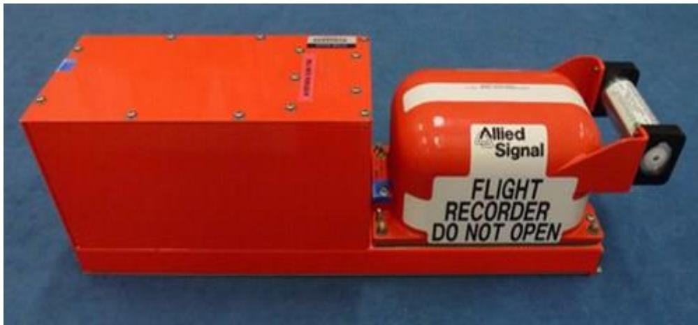
**Slika 2.** Uređaj za snimanje parametara leta zrakoplova
