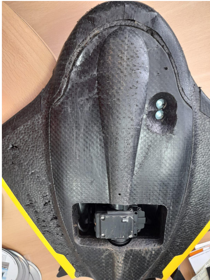
Slika 5. Oštećenja donjeg trupa nastala prilikom slijetanja bespilotnog zrakoplova
