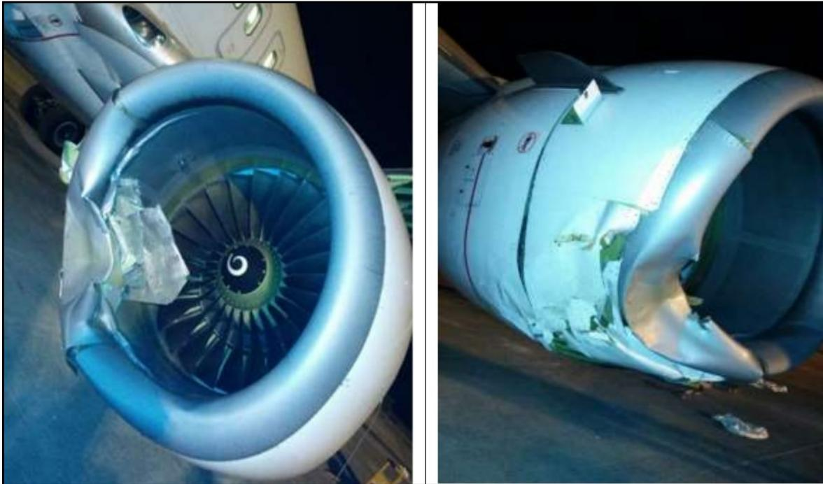
**Slika 19.** Oštećenje na lijevom motoru, [25]
