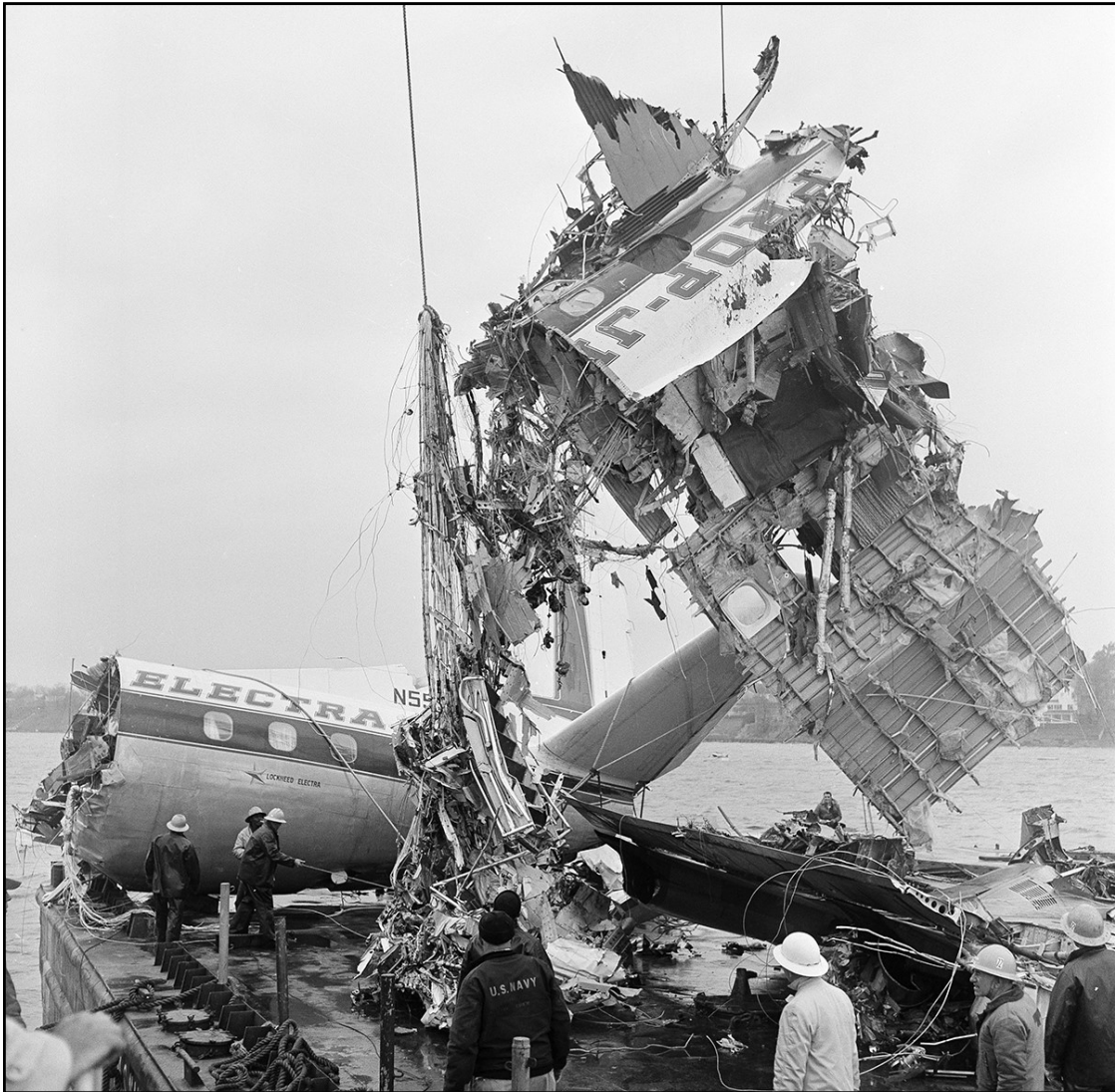
Slika 29. Dijelovi Lockheed L-188A Electra nakon udara ptica, [29]
