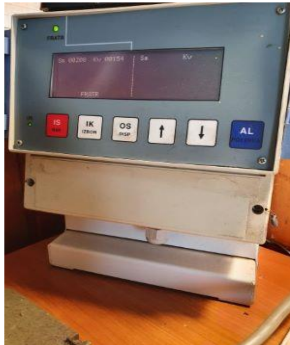
Slika 28. Uređaj za daljinski nadzor (ERP-6) ugrađen u prometnom uredu kolodvora Primorski Dolac
