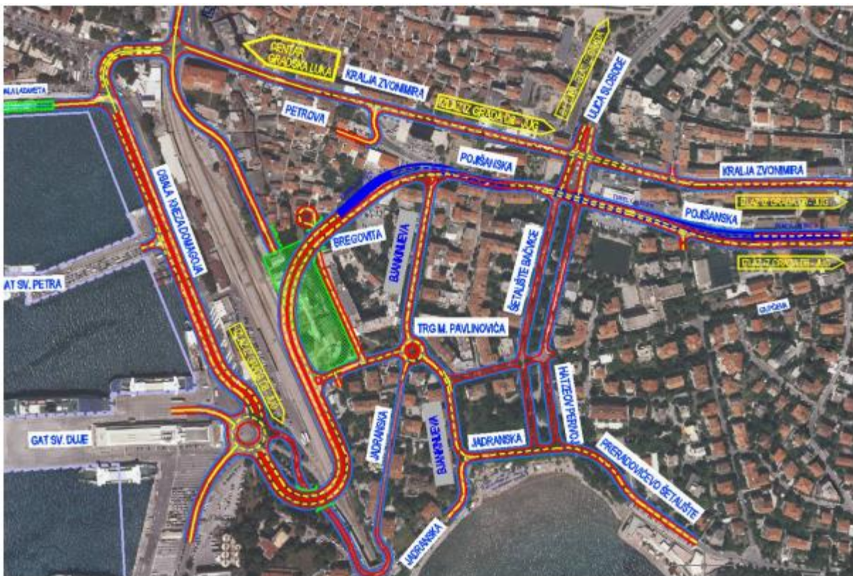
Slika 17. Prijedlog rješenja cestovnog povezivanja trajektna luke Split [29]
