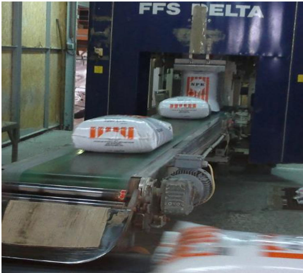
Slika 7. Izlaz gotove vreće iz stroja FFS Delta
