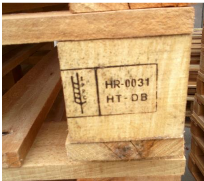
Slika 1. Označavanje termički obrađenih paleta
