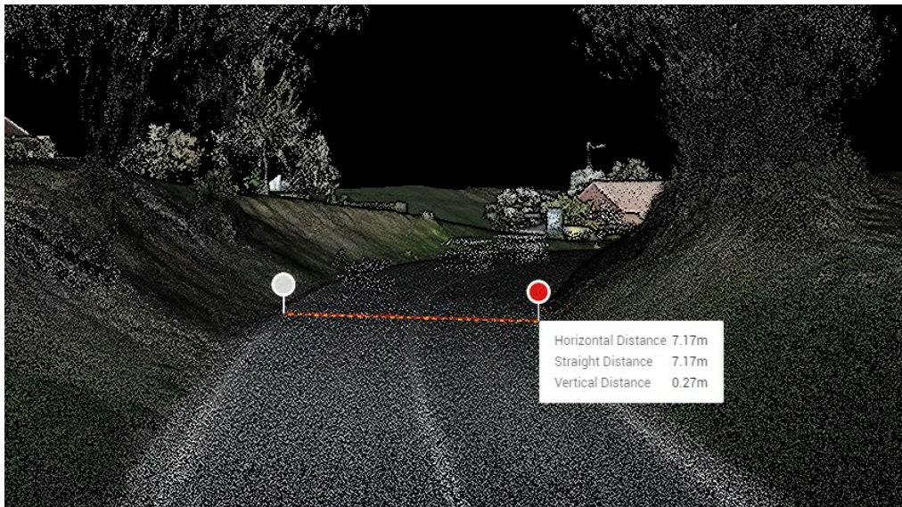
Slika 27. Mjerenje širine kolnika na 3D modelu pomoću u softverskog alata
