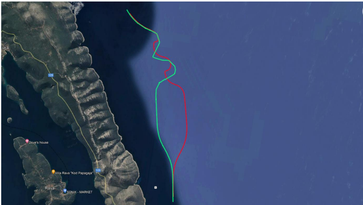
Slika 46. Putanja leta Lovca i Mete tijekom manevra "škare u horizontalnoj ravnini"
