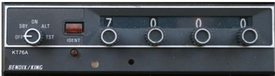
*Slika 13. Upravljački panel primopredajnika KT 76A [1]*
