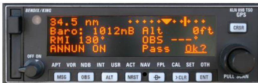
Slika 5. Upravljački panel prijavnika KLN 89B [1]
