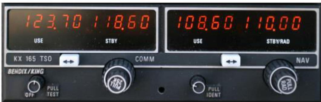
Slika 11. Upravljački panel primopredajnika KX 165 [1]
