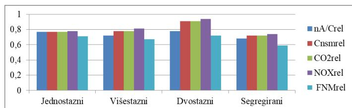
*Slika 32 Prikaz vrijednosti indikatora relativni broj letova civilnih zrakoplova (n<sub>A/Crel</sub>), relativna potrošnja goriva (C<sub>nsmrel</sub>), relativna emisija CO<sub>2</sub> (CO<sub>2rel</sub>), relativna emisija NO<sub>X</sub> (NO<sub>Xrel</sub>) i relativna duljina letova (F<sub>NMrel</sub>)*
