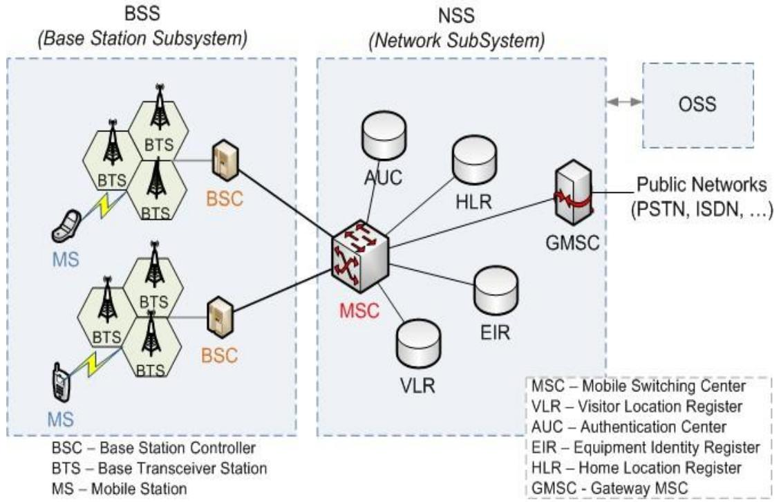
Slika 1. Arhitektura mrežnog komutacijskog podsustava. Slika preuzeta od [7]
