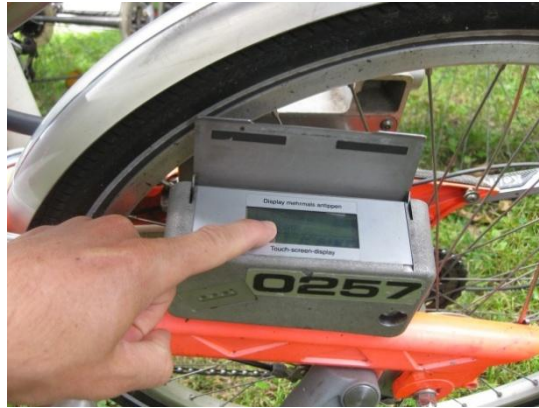
Slika 10. Sustav zaključavanja CAB-a u Munchenu.
