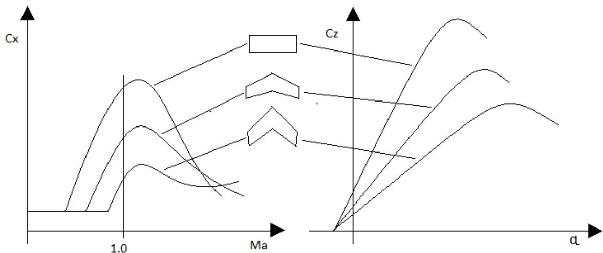
Slika 22. Promjena koeficijenata otpora i uzgona za pravokutna i strijelasta krila
