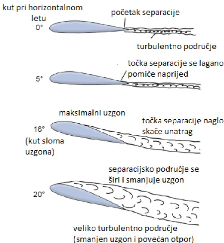
Slika 10. Odvajanje strujnica s povećanjem napadnog kuta, [8]
