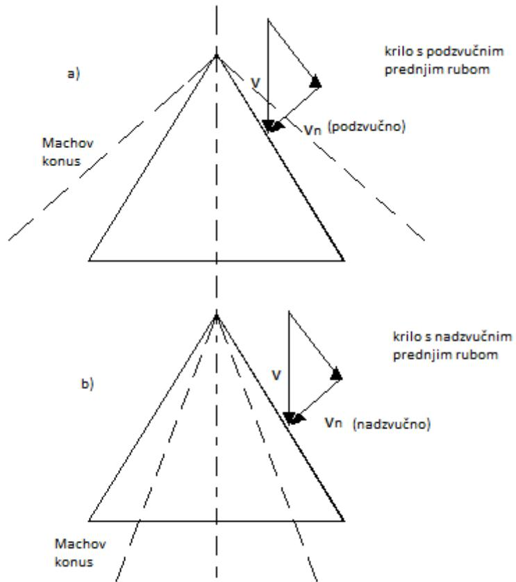
Slika 21. Delta krilo s podzvučnim i nadzvučnim rubom,
