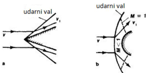
Slika 13. Ponašanje aeroprofila pri nadzvučnim brzinama, [27]
