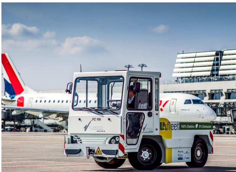
Slika 15. Električni traktor, [67]
