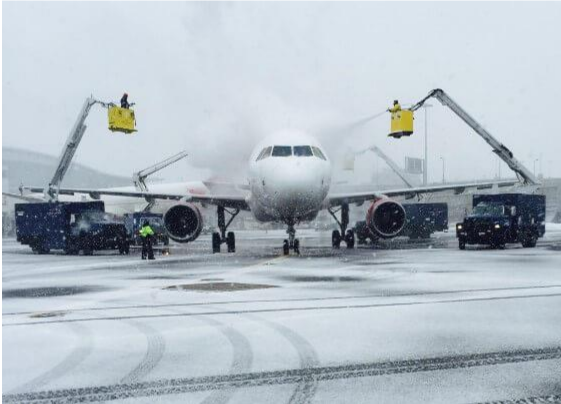
Slika 7. Proces odleđivanja zrakoplovnih površina, [29]
