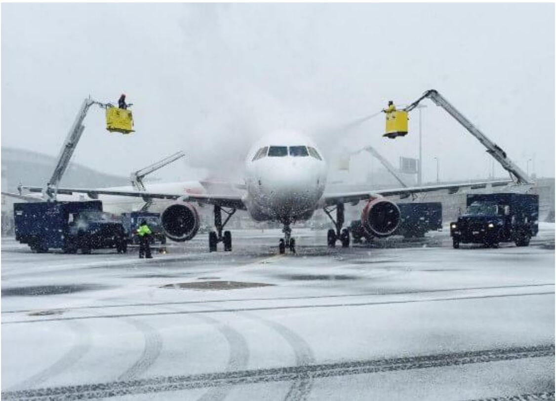
**Slika 7.** Proces odleđivanja zrakoplovnih površina, [29]
