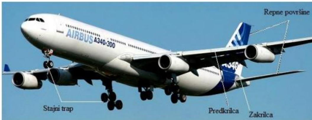
Slika 5. Strukturalni dijelovi zrakoplova koji stvaraju buku, [20]
