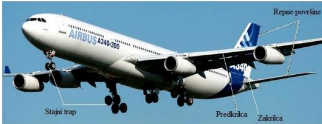
Slika 5. Strukturalni dijelovi zrakoplova koji stvaraju buku, [20]
