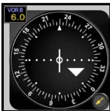
Slika 29. Očitavanje radijala pomoću CDI prikaznika
